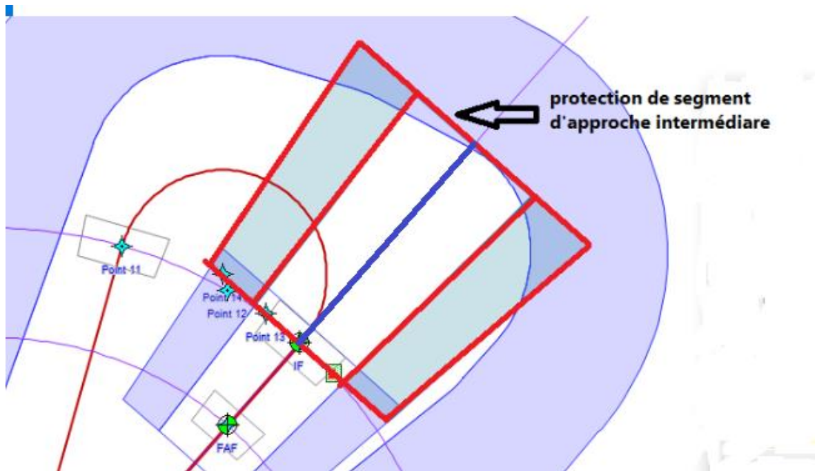
Figure 1-16 : Aire de protection du segment d'approche intermédiaire
