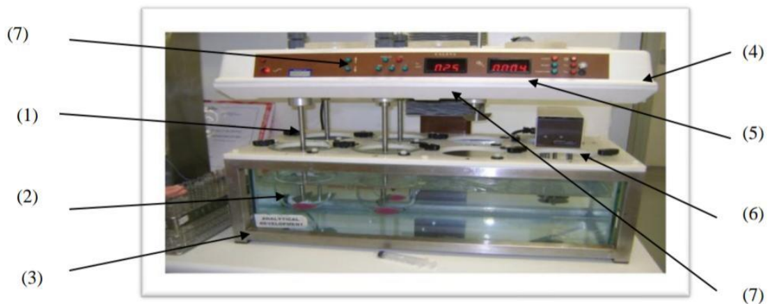
Figure 3. 2 : Photo d'un dissolu test USP à palette tournante.
