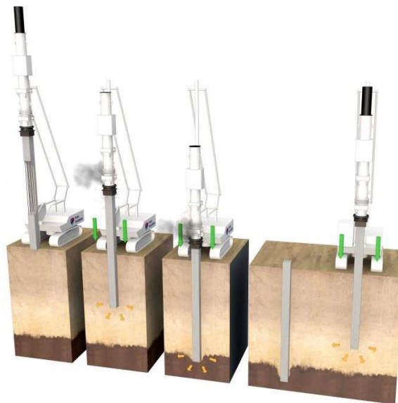
Fig.68 Technique des pieux battus
