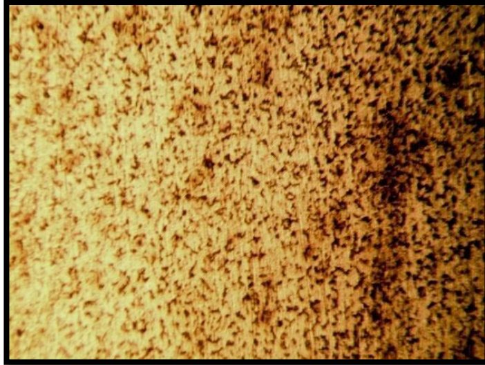
Figure IV. 12: Photographe obtenue par La microscopie de la pièce après le chromage.
