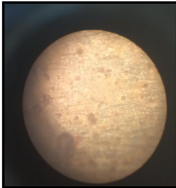
Figure IV. 3: Photographie obtenue par microscopie optique de la pièce avant chromage.
