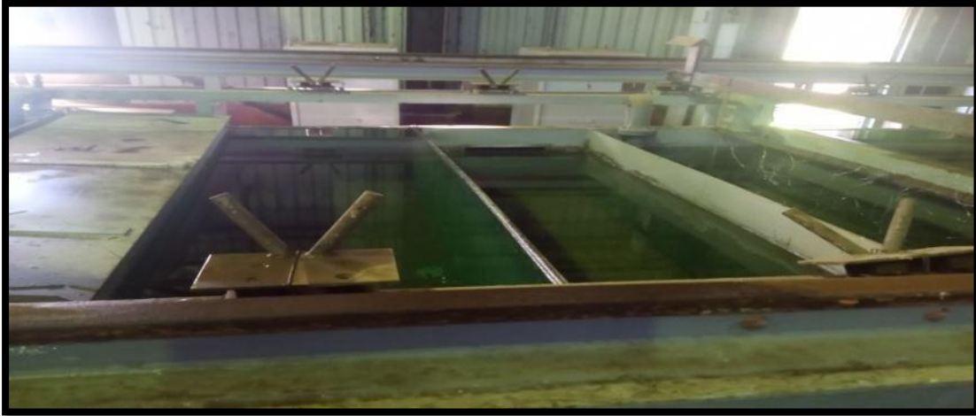
Figure III. 15: Rinçage avec l'eau distillée
