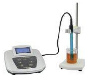
**Figure II.3 :** pH-mètre WWTW 7110 pour la mesure du pH.
