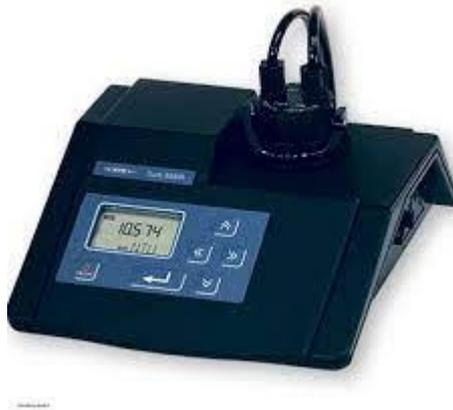
**Figure II.4 :** Turbidimètre WTW TURB IR utilisé pour la mesure de la turbidité.
