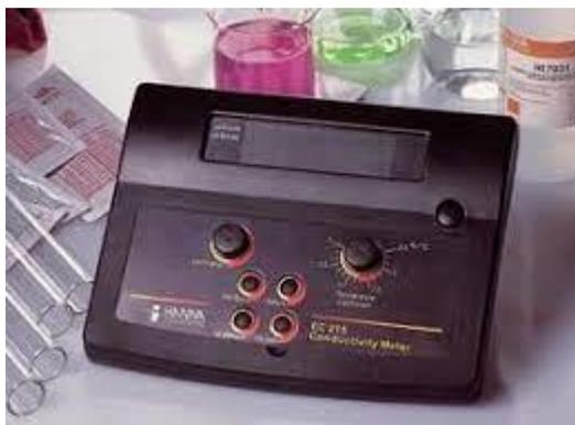
Figure II.5 : Conductimètre HANNA utilisé pour la mesure de la conductivité.
