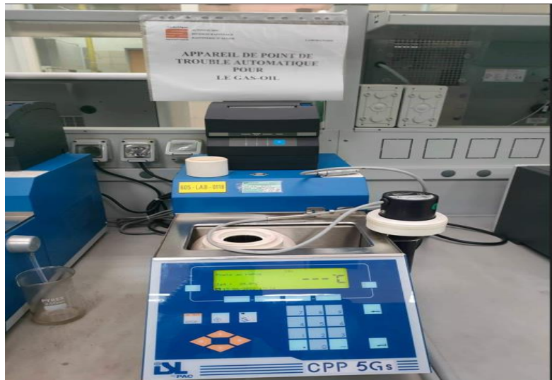
Figure 3.4 : Photo de l'appareil de mesure du point de trouble
