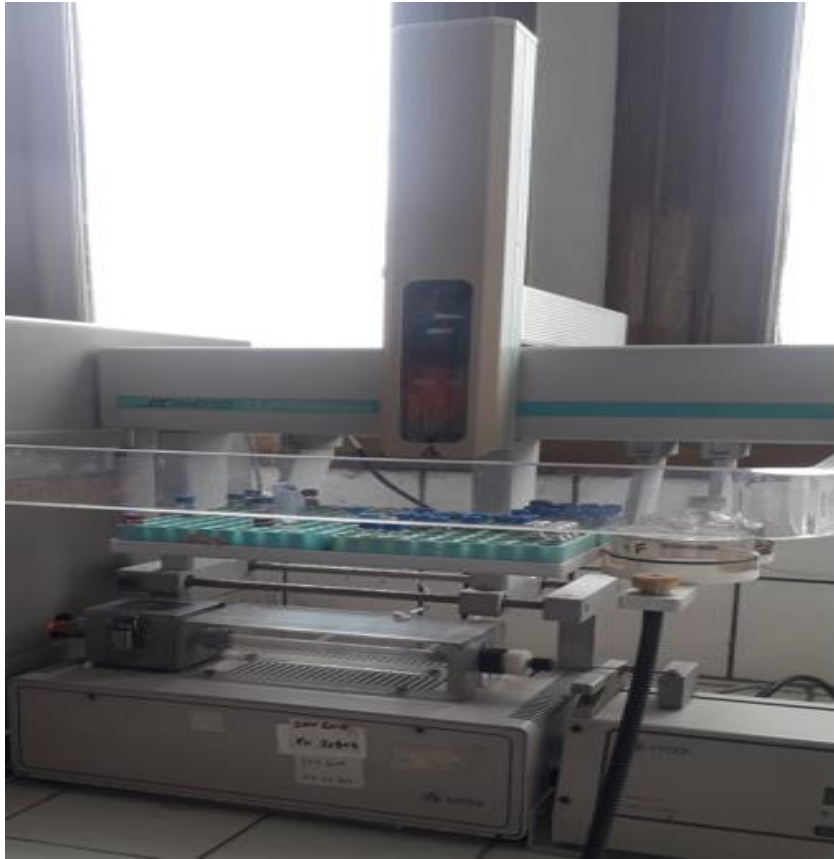
Figure 3.9: Dispositif pour la mesure de la teneur en soufre
