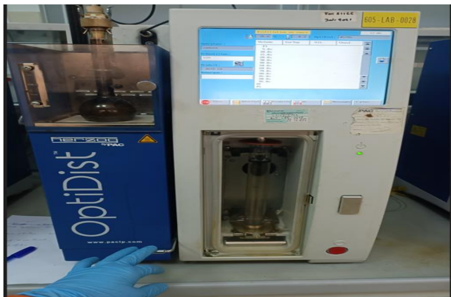
Figure 3.6 : Photo d'appareil de la distillation ASTM
