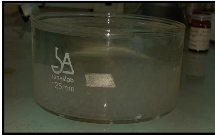
**Figure 3.2 :** la gélification complète des billes d'alginate prêtes à filtrer et mettre dans l'étuve pour 24H
