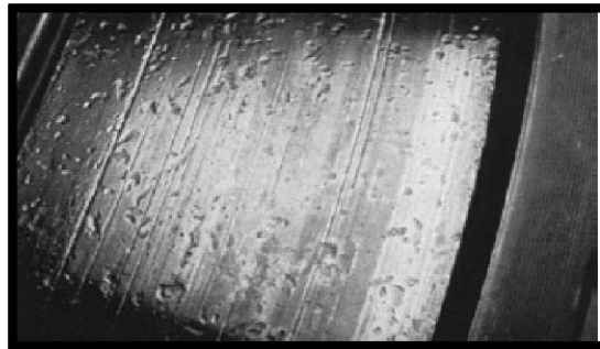
Fig. I.5. Marques d'indentation dues à la Présence de contaminant [14]
