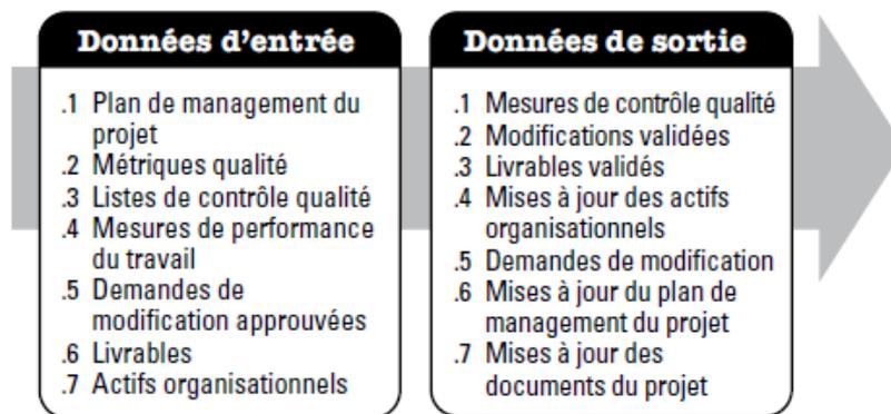
Figure III-48. Mettre en oeuvre le contrôle qualité : données d'entrée et données de sortie
