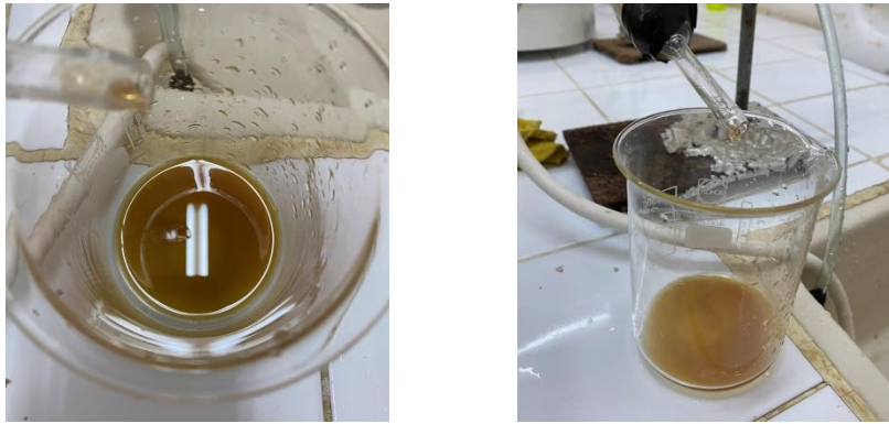
Figure 13 Résidu de distillation
