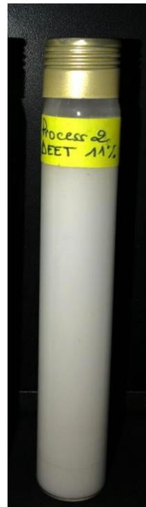
**Figure III.12** Photo représentant les optimums à  $t= 3$  semaines sous étuve et à  $T=45^{\circ}\text{C}$ .
