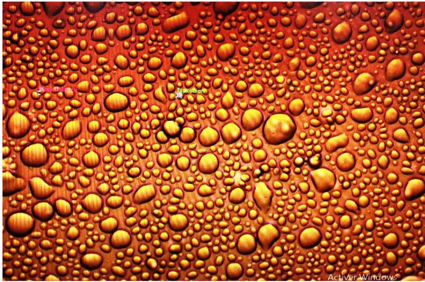
**Figure III.7:** Photo microscopique de l'optimum avec 11% DEET selon le process 2, grossissement X 40
