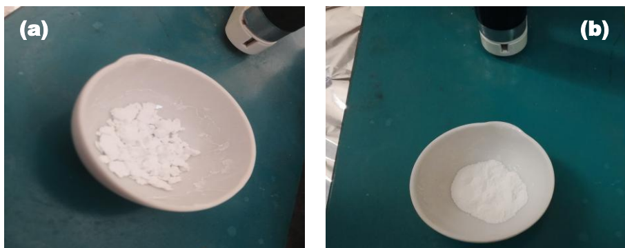
Figure 2.1 : (a) Photo de la poudre de TiO 2 synthétisé par la 1 ère méthode après l'étape de recuit ; (b) Photo de la poudre finale de TiO 2 synthétisé.
