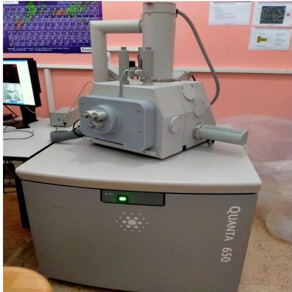
figureII.3.3 :l'appareil de MEB utilisé pour les observation microscopique des échantillon [ 65].
