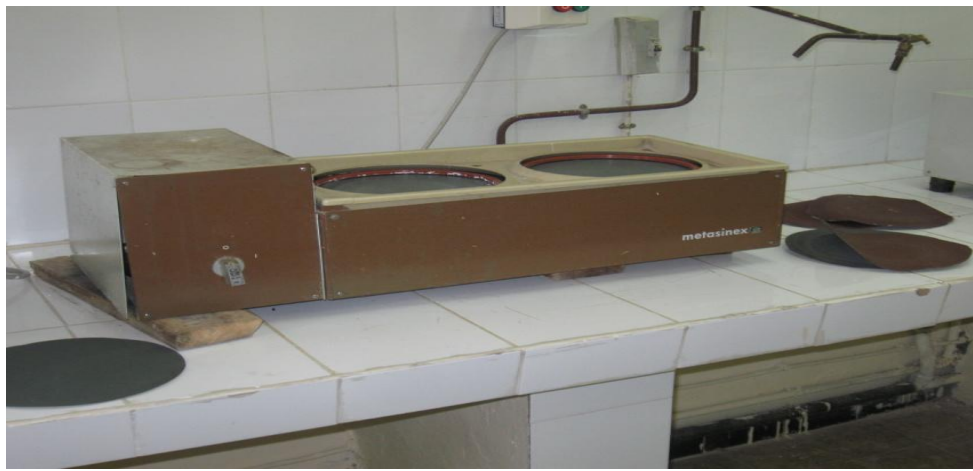
Figure III-6 Polisseuse aux papiers abrasifs
