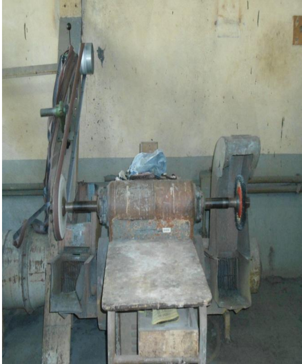
Figure III:1 polisseuse à la brosse métallique et papiers abrasifs
