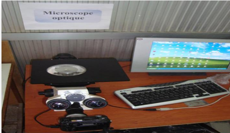
Figure III -8 : Microscope optique utilisé pour l'analyse métallographique
