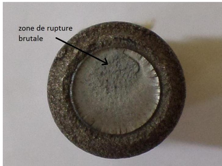
Figure 4.12 rupture par fatigue d'une éprouvette avec revêtements 1009+30%WC17CO
