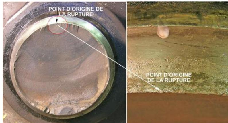
Figure 2.1 rupture par fatigue
