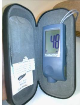
Figure 3.8 appareil de mesure des couches de revêtement
