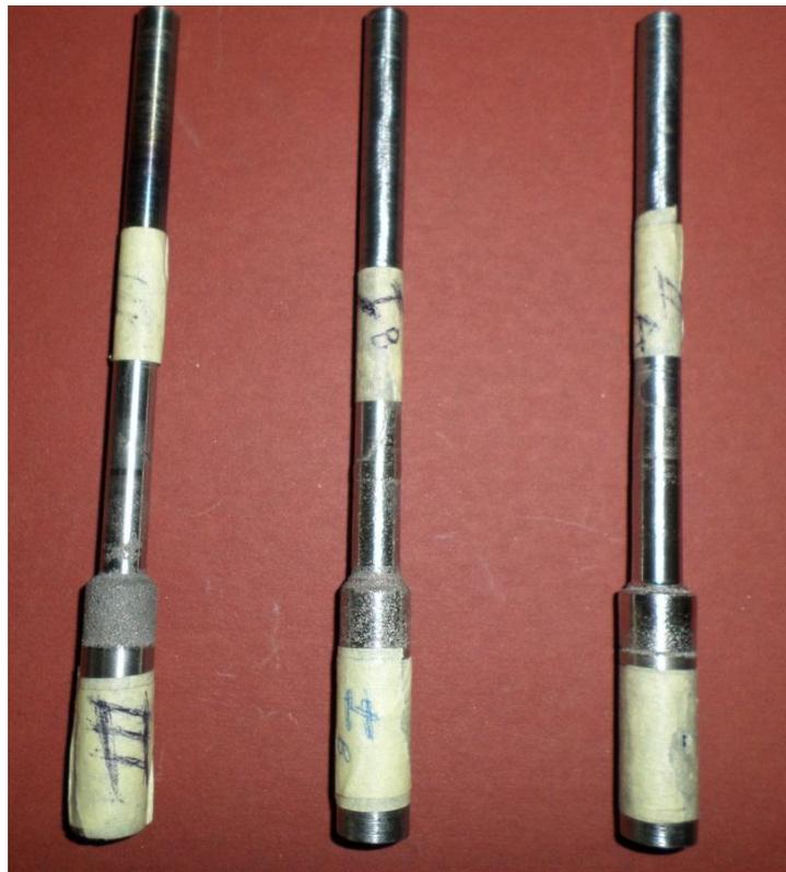
Figure 4.3 Eprouvettes projetés avec la poudre 1009+30% WC17Co
