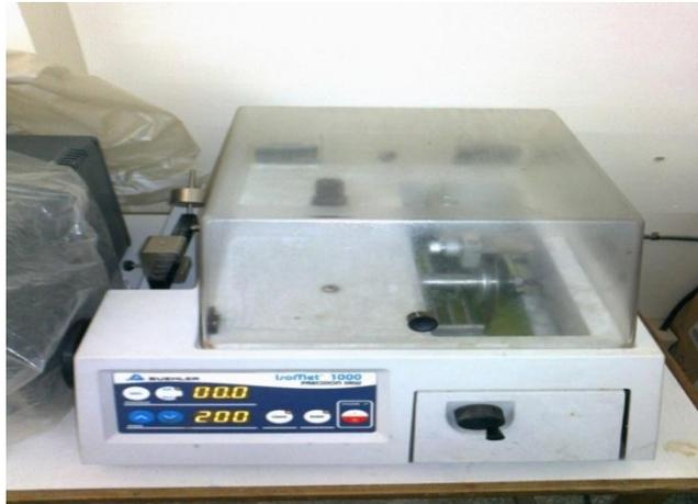
Figure 3.11 micro tronçonneuse
