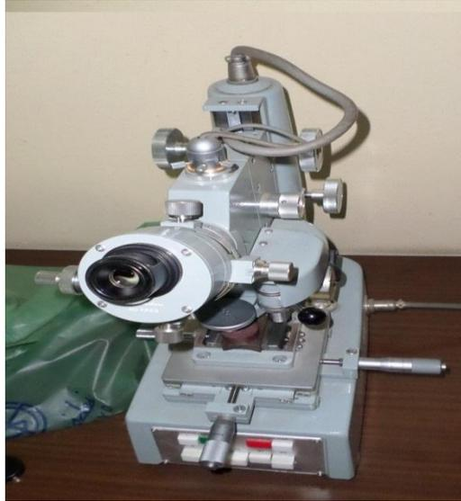
Figure 3.17 Microduromètre
