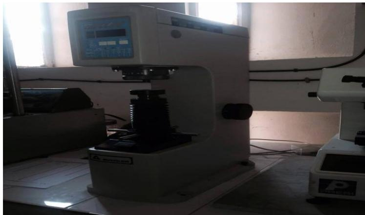
Figure 3.18 duromètre
