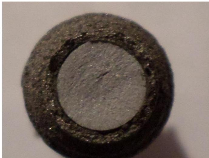
Figure 4.13 rupture par fatigue d'une éprouvette avec revêtements 1009+30%~WC17CO
