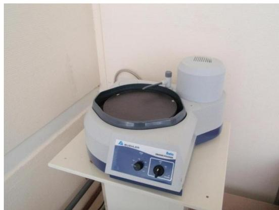
Figure 3.14 Polisseuse de finition
