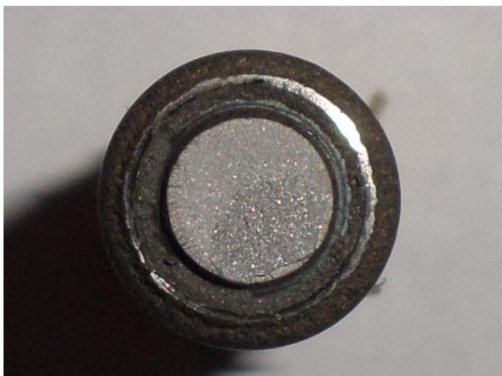
Figure 4.16 rupture par fatigue d'une éprouvette avec revêtements 21031 profondeur 0.9 mm
