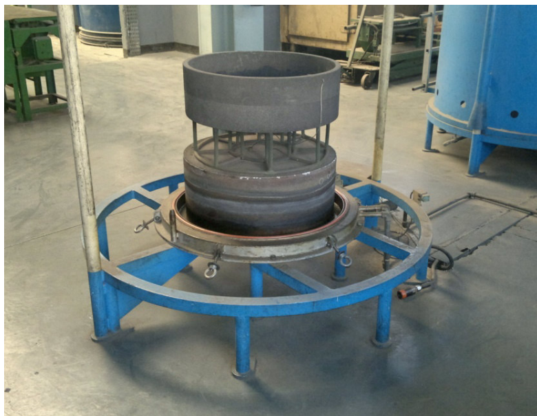
Figure III.10: Sole du four avec un system de refroidissement.
