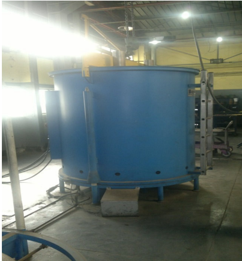
Figure III.9: Four à hydrogène.
