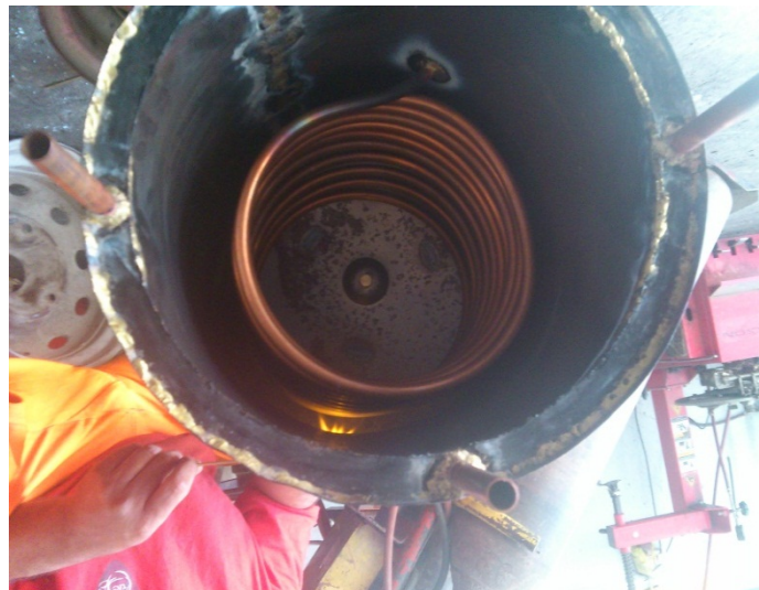
Figure III.11 : l'emplacement de l'échangeur
