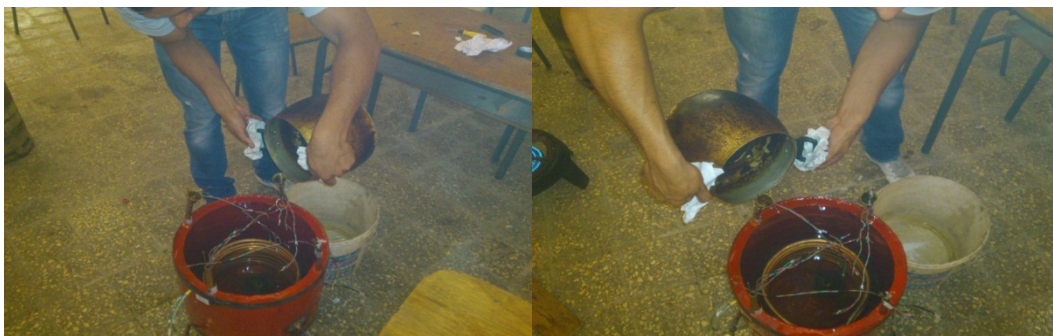
Figure III. 15 : l'injection de la paraffine.
