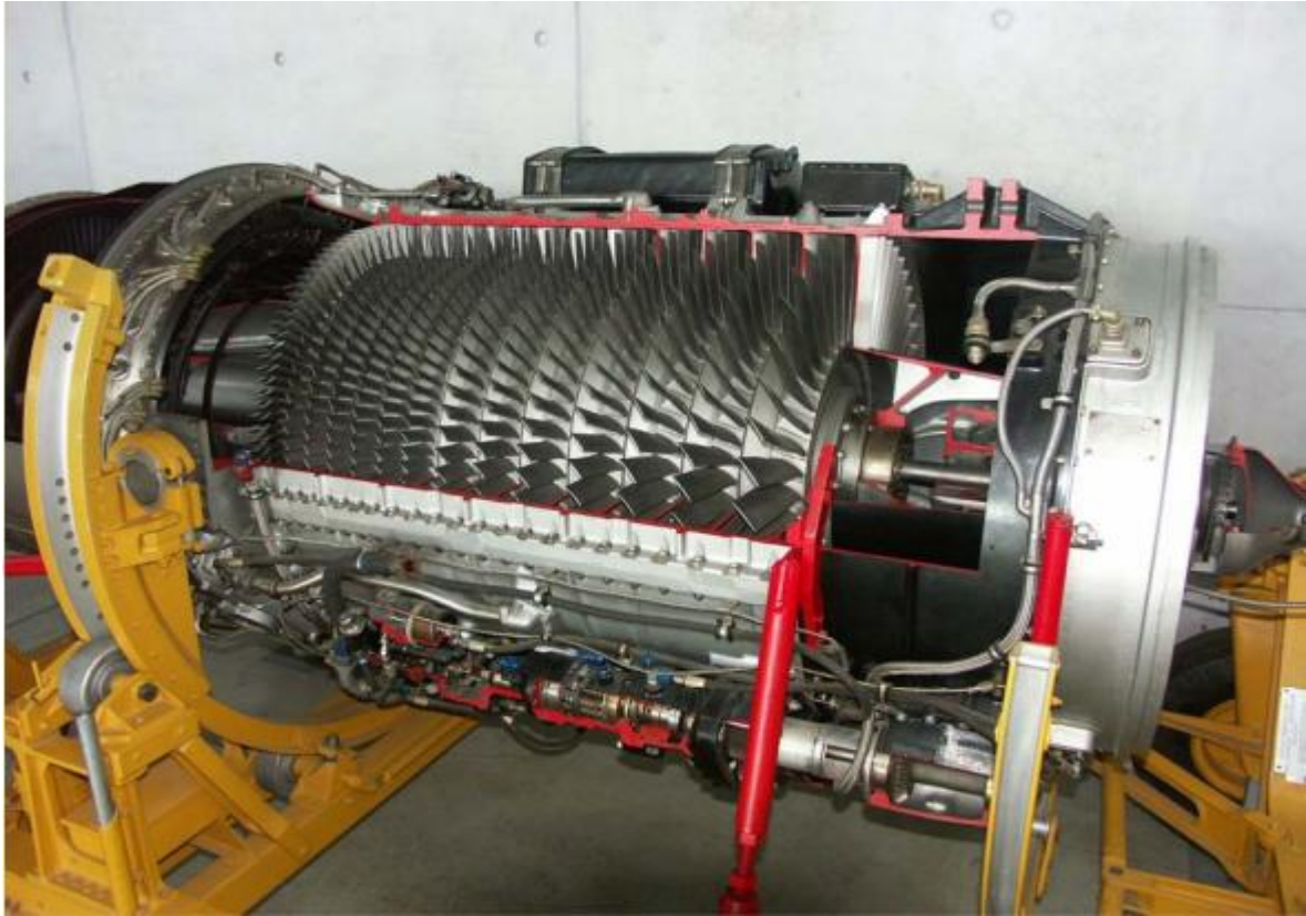
Figure 1.5 : Compresseur simple corps: Curtiss-Wright J65
