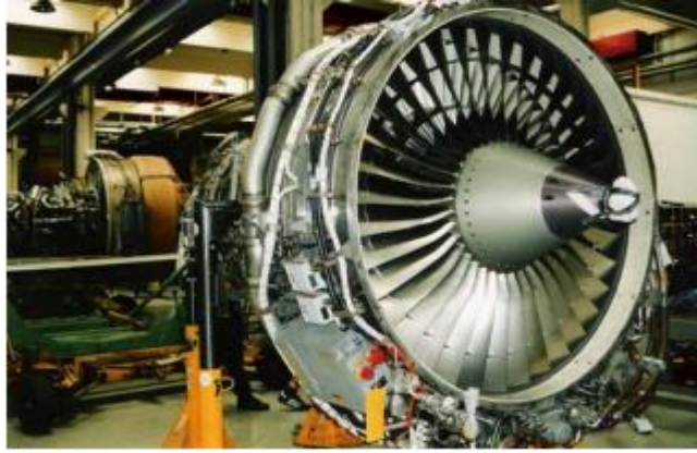
Figure 1.9 : La soufflante d'un CFM56
