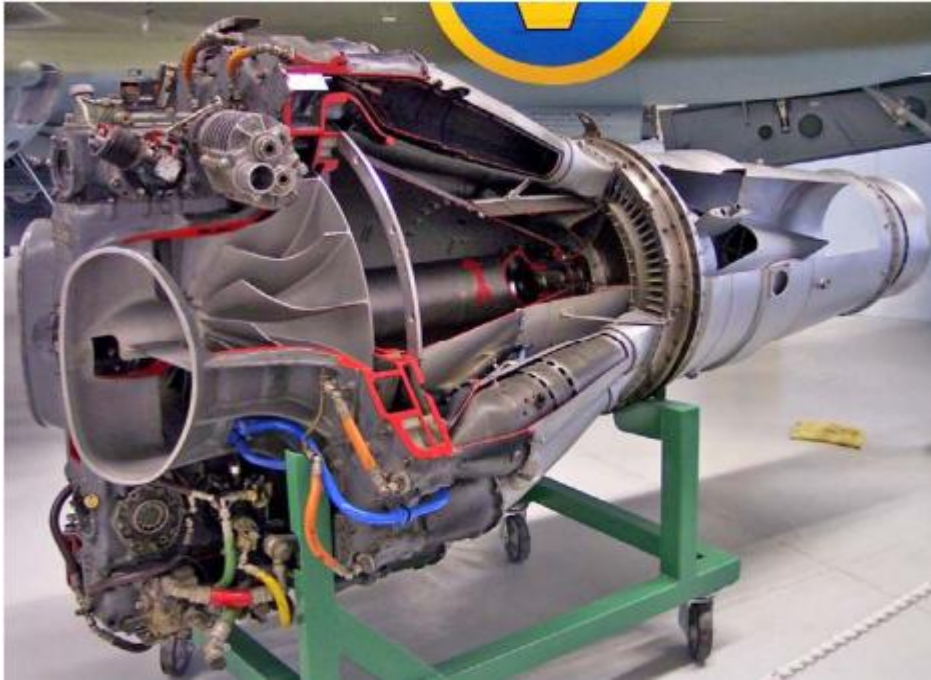
Figure 1.2 : Schéma de principe De Havilland "Goblin"
