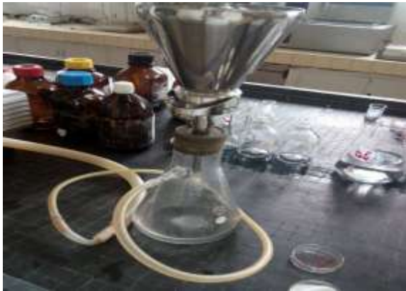
Ensemble de filtration « MES »
