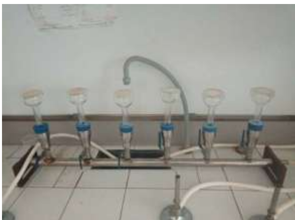
Figure : Rampe de filtration
