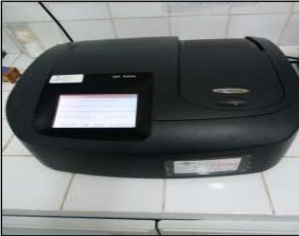
*Spectrophotomètre d'absorption moléculaire*
