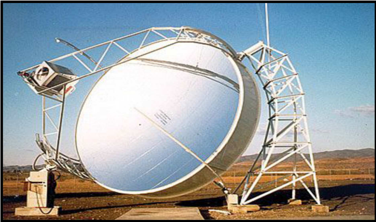
Figure 1.17 : schéma d'un Capteur parabolique couplé à un moteur Stirling (Source : [24])
