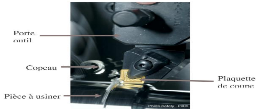
Figure II.1: Outil de coupe lors d'une opération de tournage.
