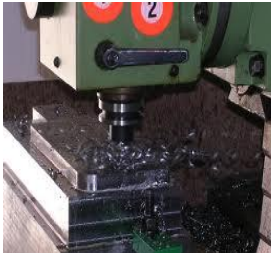
Figure I.14 : Procédé de fraisage
