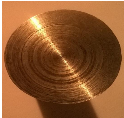
Figure IV.15 : Image réelle de la surface usinée ; f = 0.05\text{mm/tr} , re = 1.2\text{ mm}
