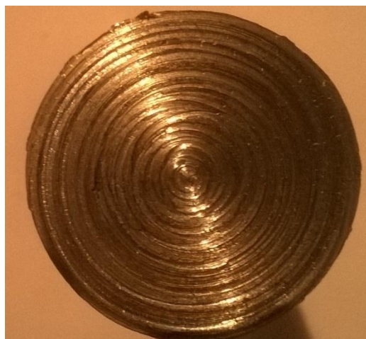
Figure IV.21 : Image réelle de la surface usinée ; f = 0.2\text{mm/tr} , re = 1.2\text{ mm}
