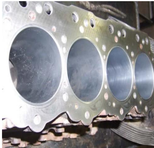
Figure I.16 : Procédé de rectification
