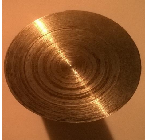
Figure IV.17 : Image réelle de la surface usinée ; f = 0.2\text{mm/tr} , re = 0.4\text{ mm}
