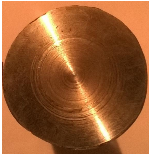
Figure IV.11 : Image réelle de la surface usinée ; f = 0.2 mm/tr, re = 0.4 mm
