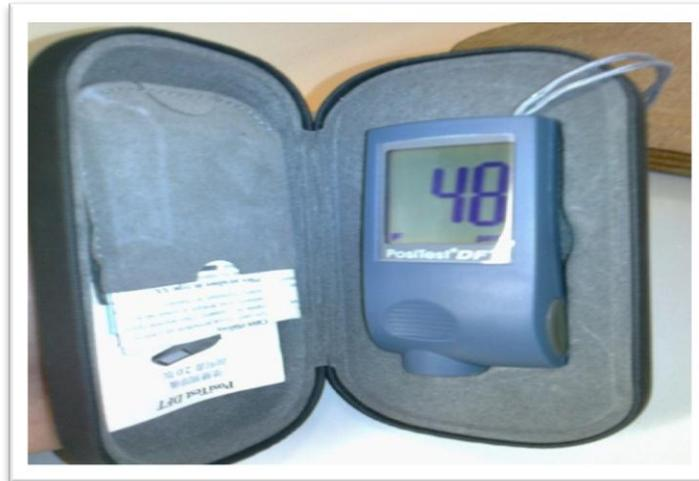
Figure 3.6: Appareil de mesure des couches de revêtements
