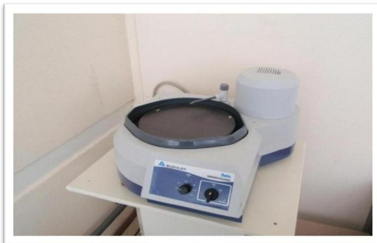
Figure 3.11: Polisseuse de finition
