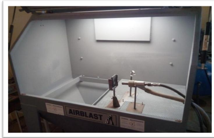
Figure 3.19: appareil d'érosion (Grenailleuse)
