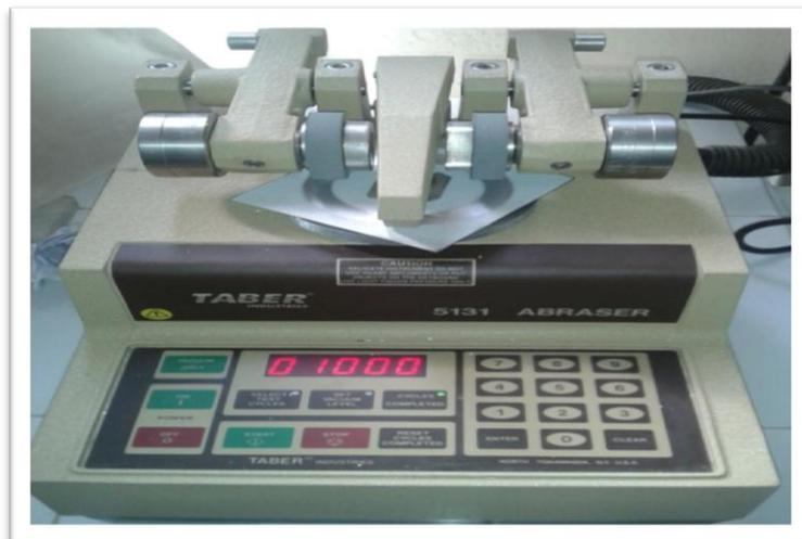
Figure 3.14: abrasimètre circulaire Taber 5131
