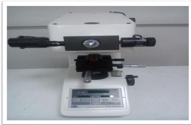
Figure 3.17: micro-dure mètre TESTWELL type FM-300
