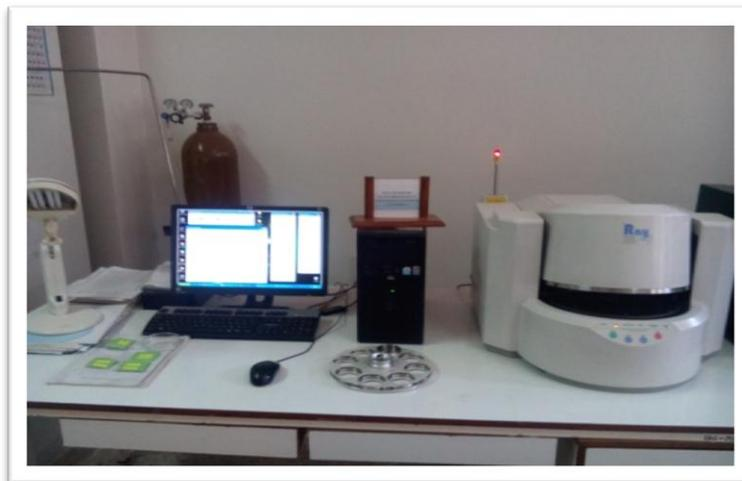
Figure 3.18: Spectromètre de fluorescence X 800HS
