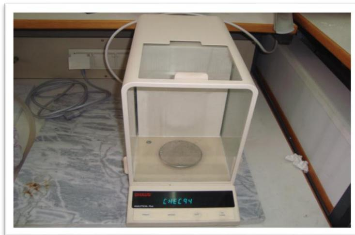
Figure 3.7: Balance électronique
