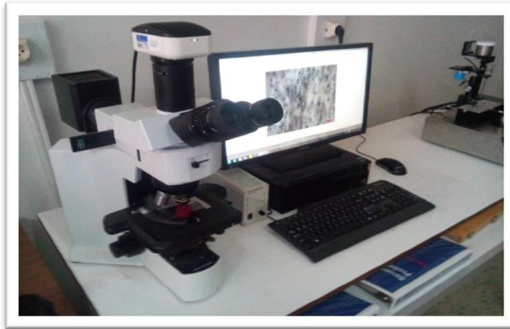
Figure 3.12: Microscope optique
