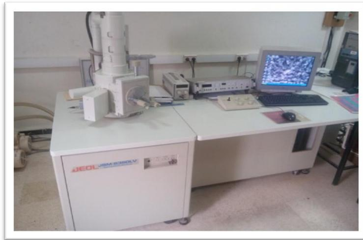
Figure 3.13: appareil de Microscope Electronique à Balayage
