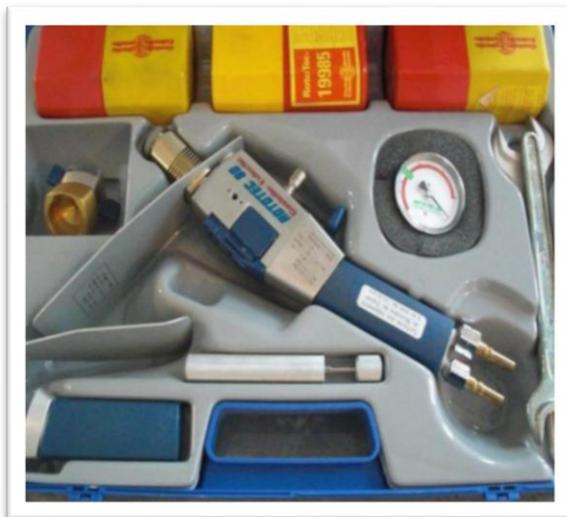
Figure 3.4: Torche à flamme Roto tec 80 Castolin Eutectic.
