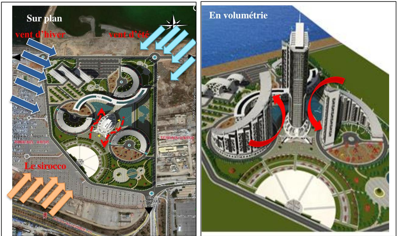
**Figure 18: Schéma du vent entrant est en effet dévié par les tours**
