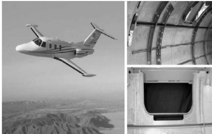
Figure 2.6 : Assemblage de l'avion Eclipse avec le procédé de FSW [2.7]
