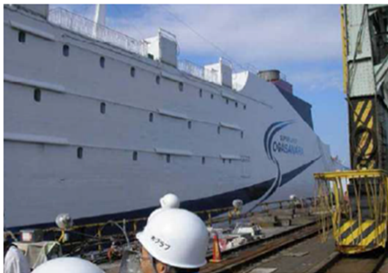
Figure 2.7 : Bateau en aluminium construit en utilisant le procédé FSW [1.8]
