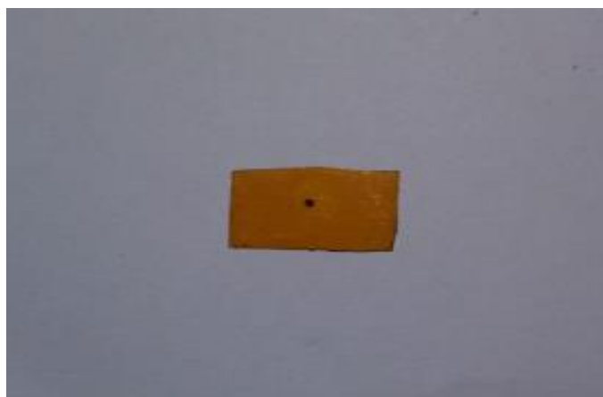
Figure II. 1. Source de ^{22}\text{Na} sur le support de kapton.
