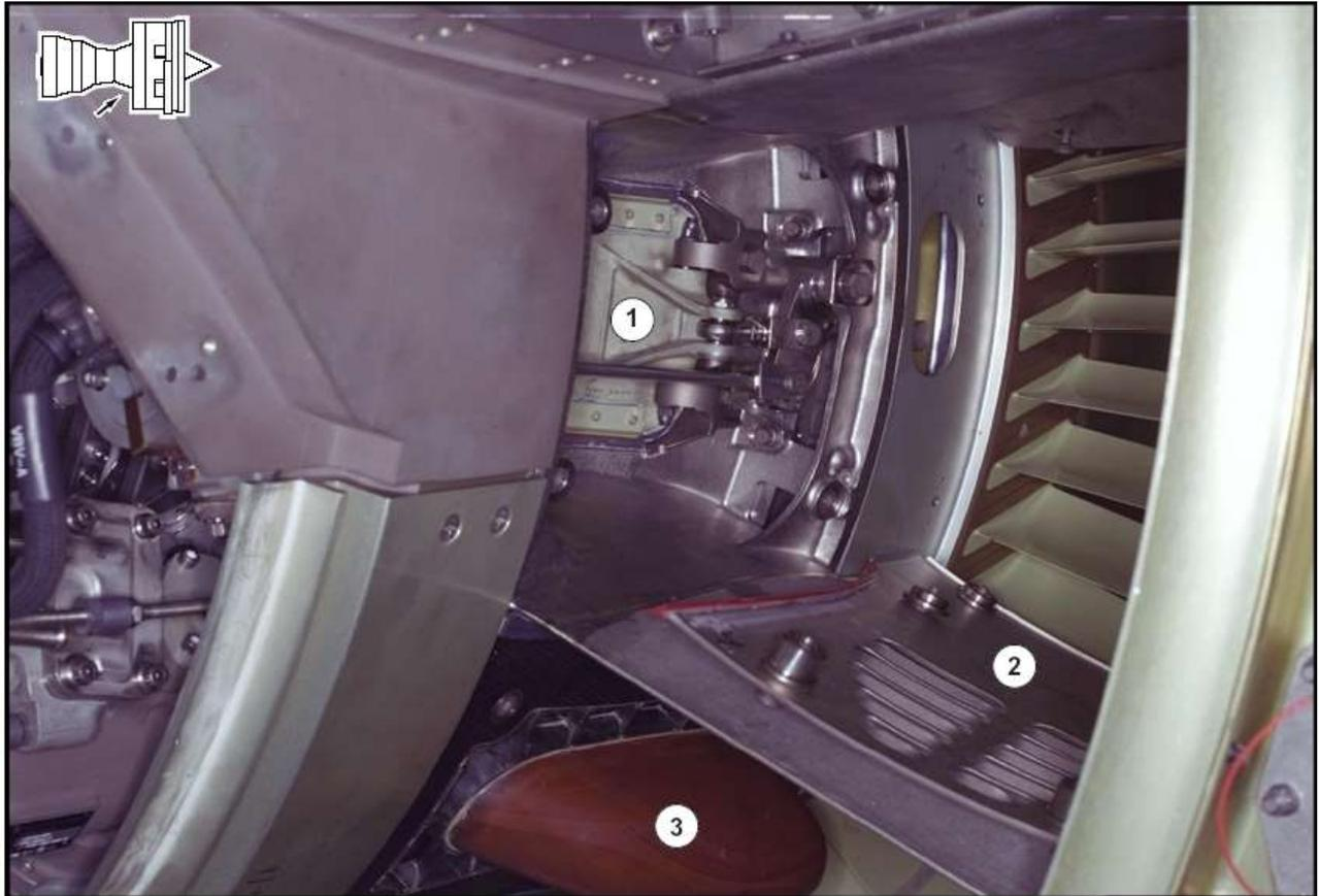
Les vérins *VBV* sont à double effet et actionné hydrauliquement par le *servofuel* a partir de la *HMU* qui leur commande une position qui a été calculer par la EEC en se basant sur les valeurs des variables *P0,PT,TAT, T25, VSV* position, *N1 et N2 et la TLA*.
