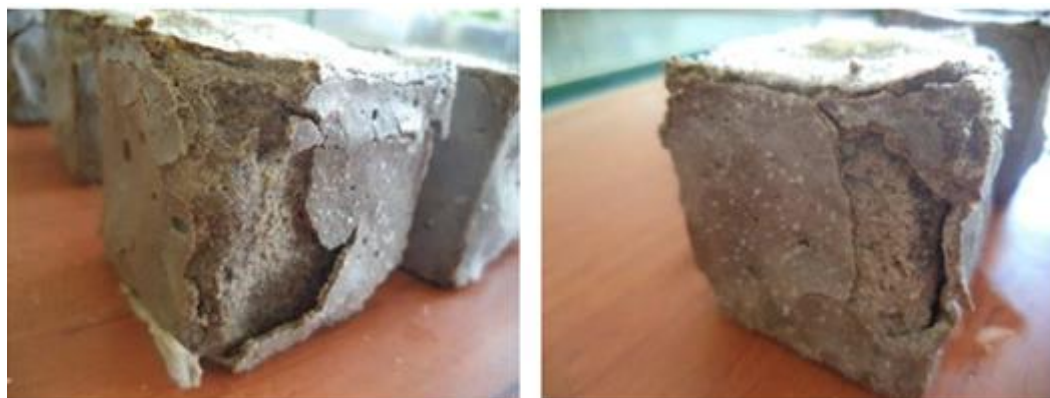
Figure 1.7 : Etat des mortiers après 12 mois d'exposition à une solution de MgSO_4 à 5^\circ C [41].
