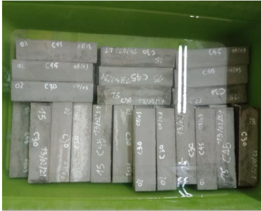
Figure 3.16 : Cycle de mouillage (bac d'eau de robinet).
