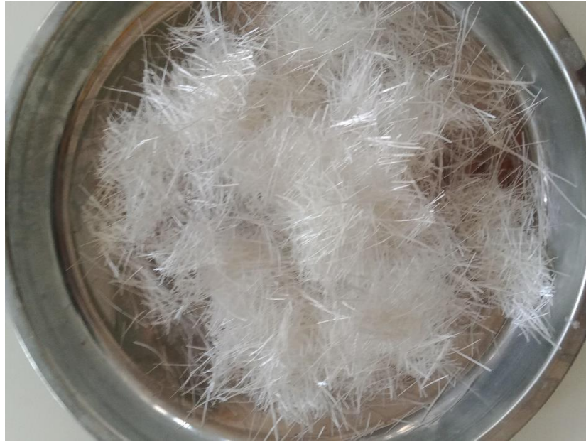
Figure 3.8 : Séparation des fibres de verre de l'époxy.
