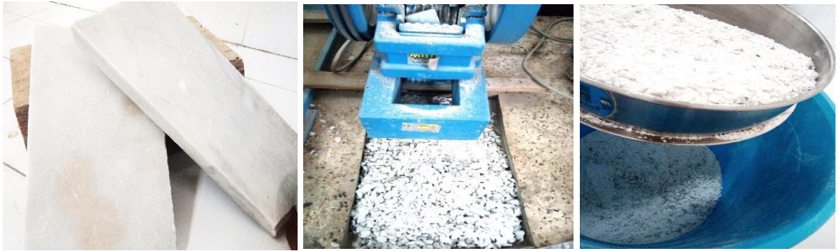
Figure 3.4 : Procédure de préparation du sable de marbre.
