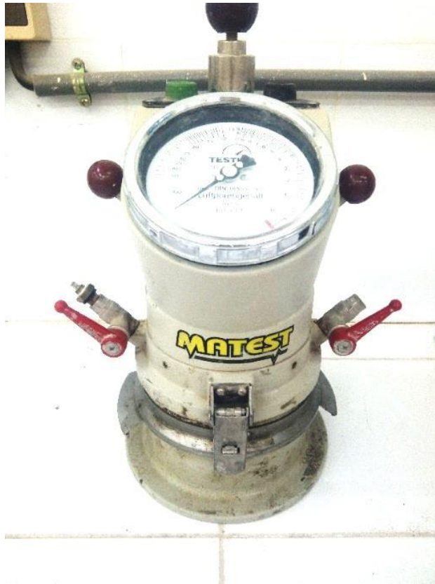
Figure 3.12 : Dispositif pour l'essai de l'air occlus.
