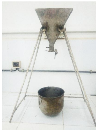
Figure 3.11 : Dispositif de l'essai d'écoulement.
