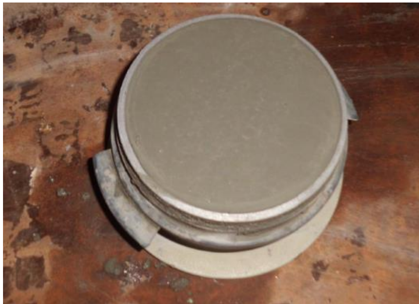
Figure 3.13 : Préparation du mortier pour l'essai de l'air occlus.
