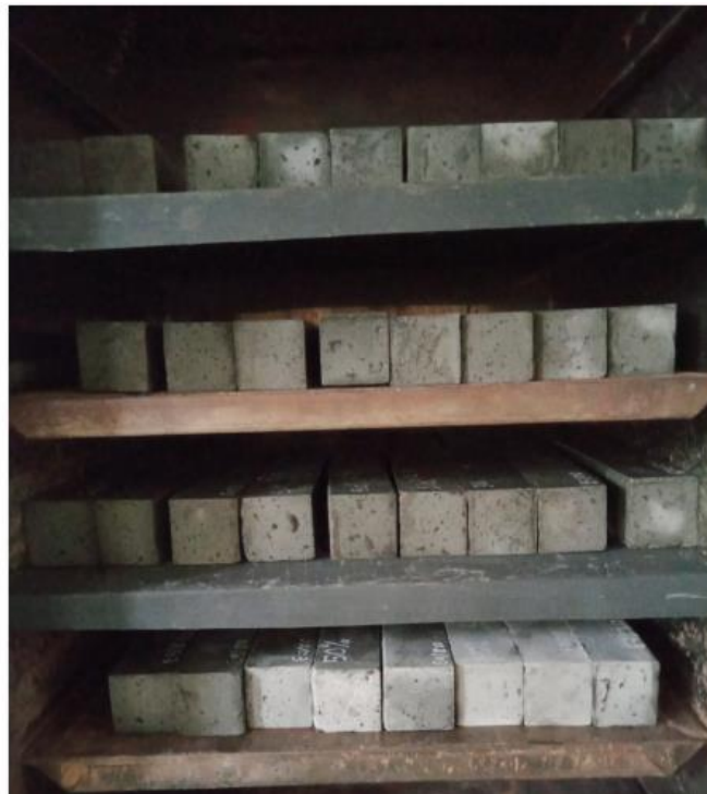
Figure 3.17 : Cycle de séchage (dans l'étuve).
