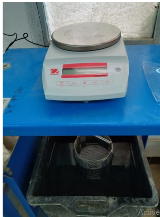
Figure 3.15 : Dispositif pour la pesée dans l'eau.
