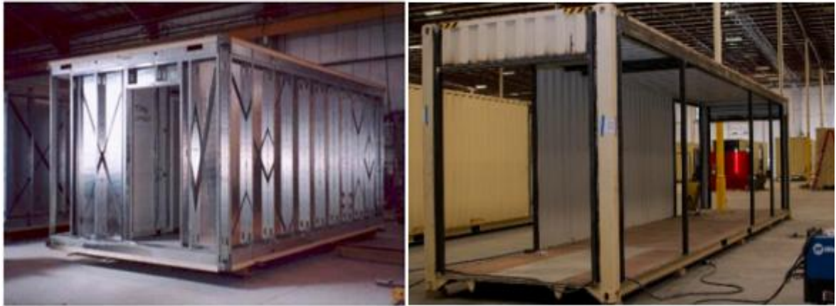
(a) Construction préfabriquée en usine [40].
