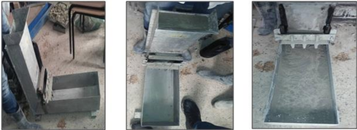
Figure 2.12 : Méthodologie de l'essai de la boîte en forme de L (L-Box).
