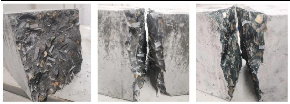
Figure 1.48 : Perspectives des surfaces fracturées des poutres en béton autoplaçant (BAP) renforcées par des fibres plastiques recyclées (FPR) avec des agrégats recyclés (AR).
