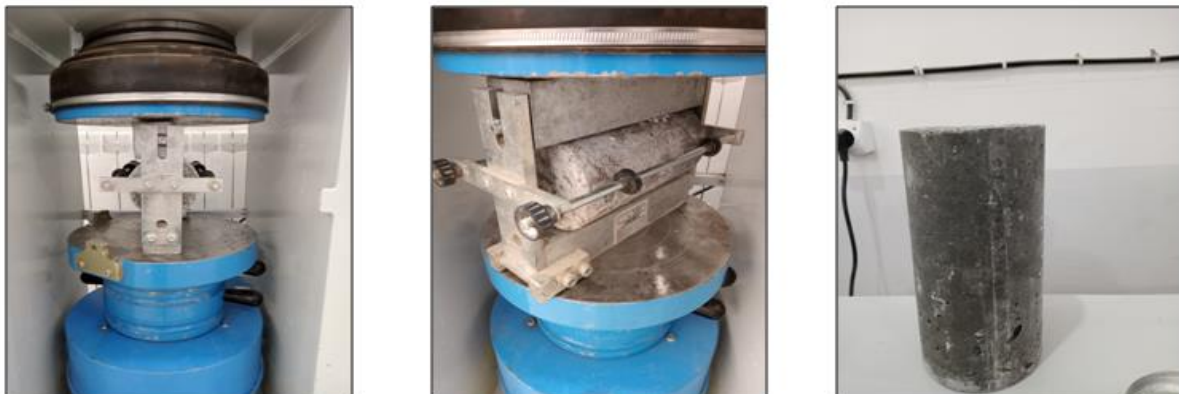
Figure 2.15 : Test de résistance à la traction par fendage.
