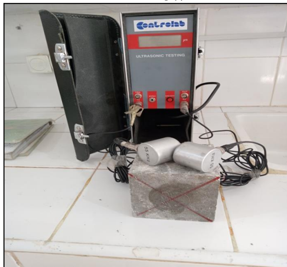
Figure 2.18: Mesure de la vitesse d'auscultation sonore.
