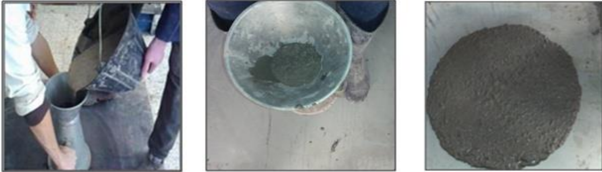
Figure 2.10 : Essai d'étalements au cône d'Abrams.
