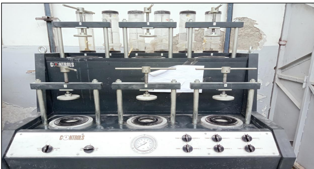
Figure 2.20 : Essai de perméabilité a l'eau.
