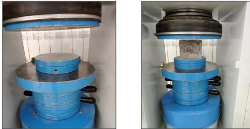
Figure 2.14: Test de résistance à la compression.
