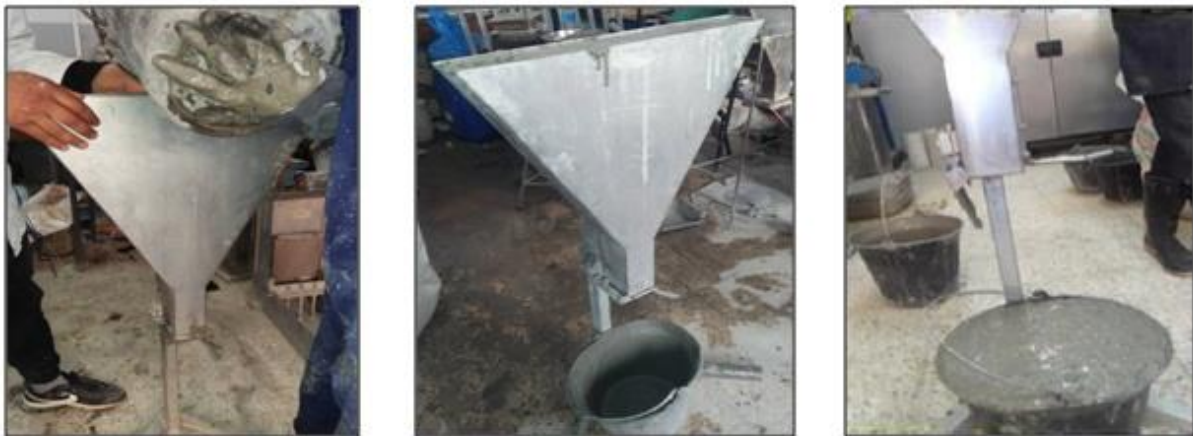
Figure 2.11: Méthodologie de l'essai à l'entonnoir en (V-Funnel).
