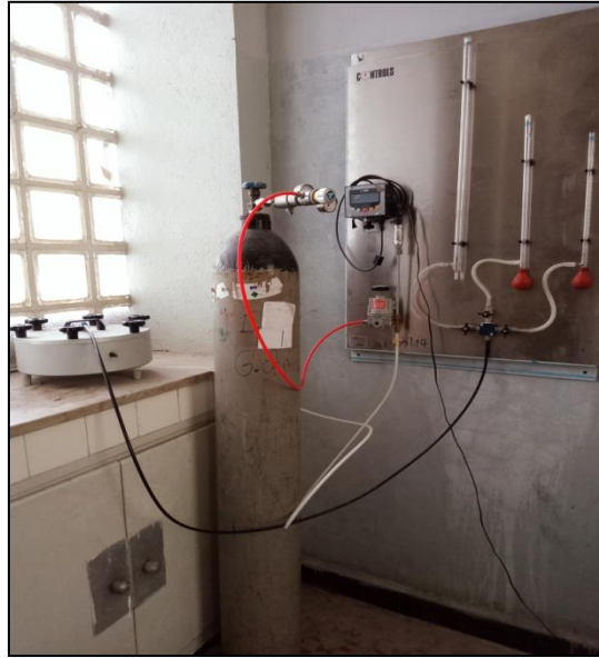
Figure 2.21. Dispositif de l'essai de perméabilité au gaz.
