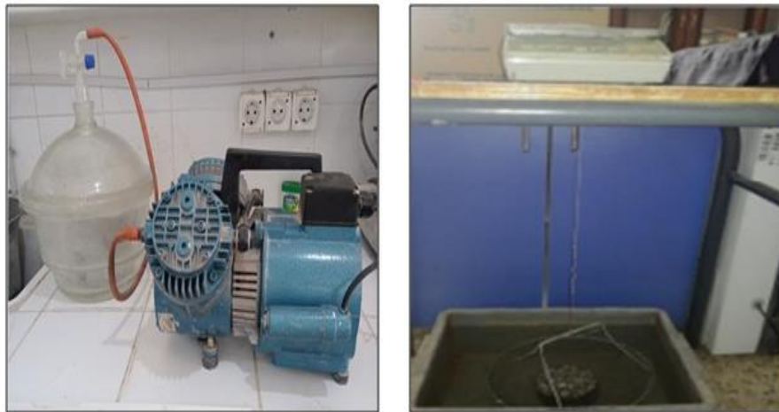
Figure 2.19: Essai de porosité.
