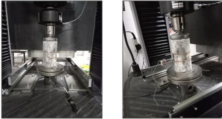
Figure 2.17 : Essai de module d'élasticité.
