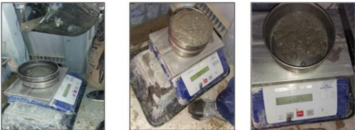
Figure 2.13: Protocole de l'essai de stabilité au tamis.
