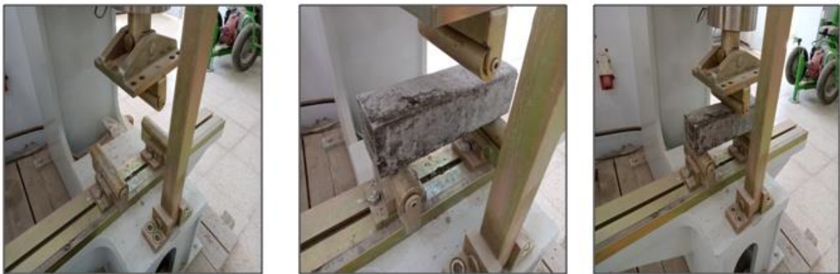
Figure 2.16 : Essai de résistance à la flexion de trois points.
