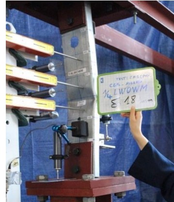
(a) 1/4LWOWM- charge de compression maximal (b) 1/4LWOWM-Fin de l'essai Figure 3.9 : Déformée Monotonique - spécimens 1/4LWOW
