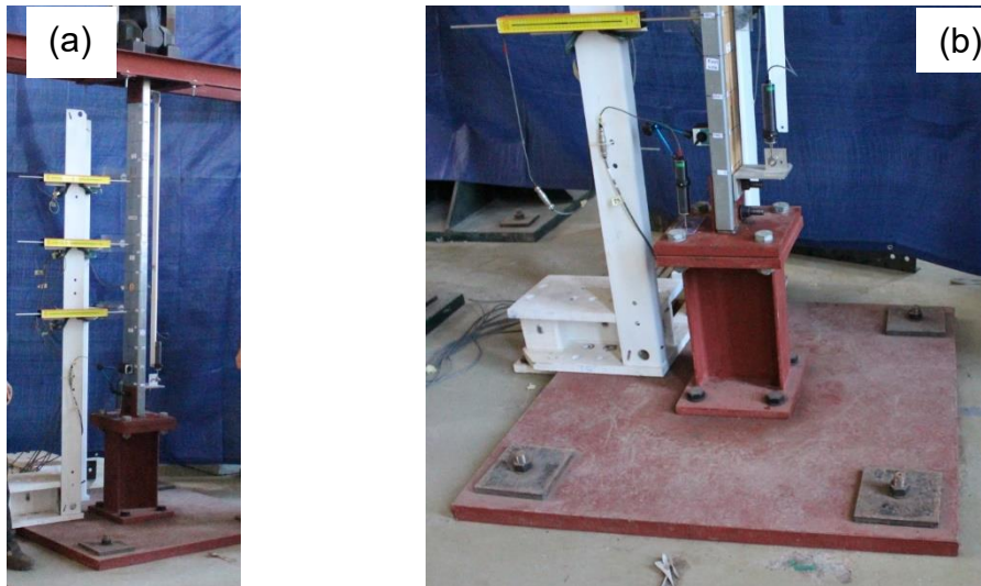
Figure 3.1 : Schéma d'instrumentation: (a) Vue globale (b) Fixation inférieure
