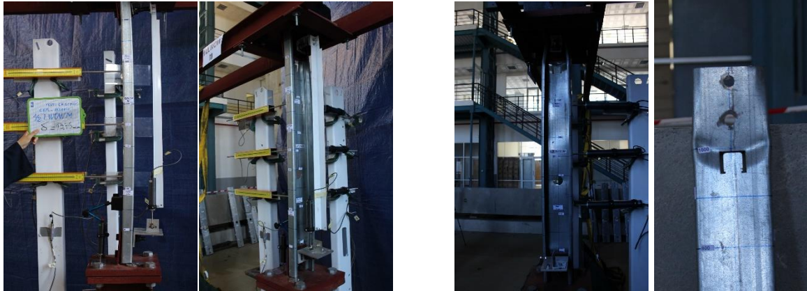
(a) 1/2LWOWM- charge de compression maximal (b) 1/2LWOWM-Fin de l'essai Figure 3.7 : Déformée Monotonique - spécimens 1/2LWOW
