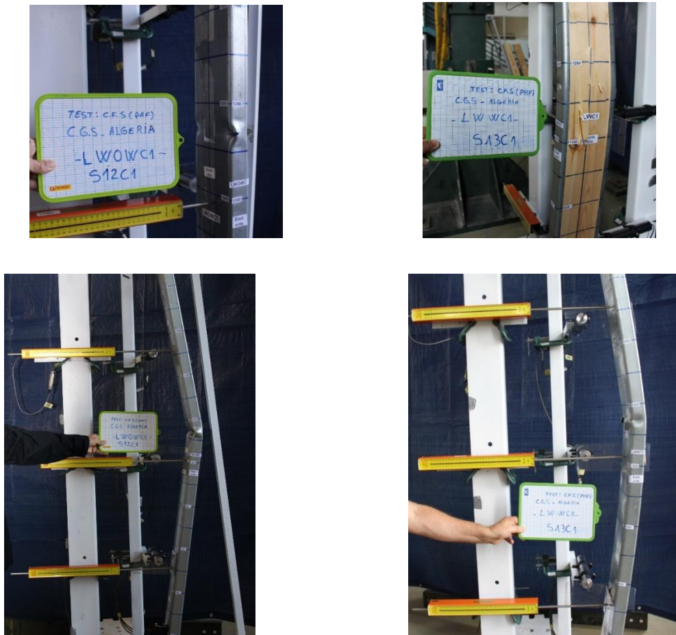
Figure 3.12 : Déformations des spécimens LWOW et LWW sous chargement cyclique
