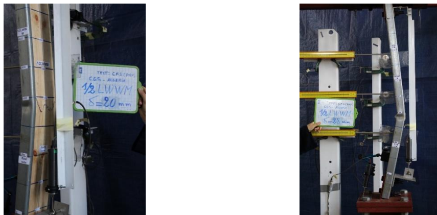
(a) Ecrasement du bois (b) 1/2LWWM-Fin de l'essai Figure 3.8 : Déformée Monotonique - spécimens 1/2LWW
