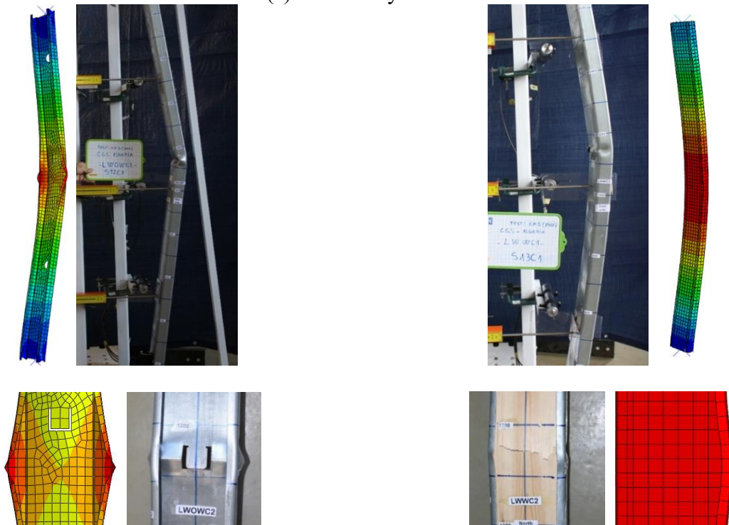
(b) Déformation globale et voilement local
