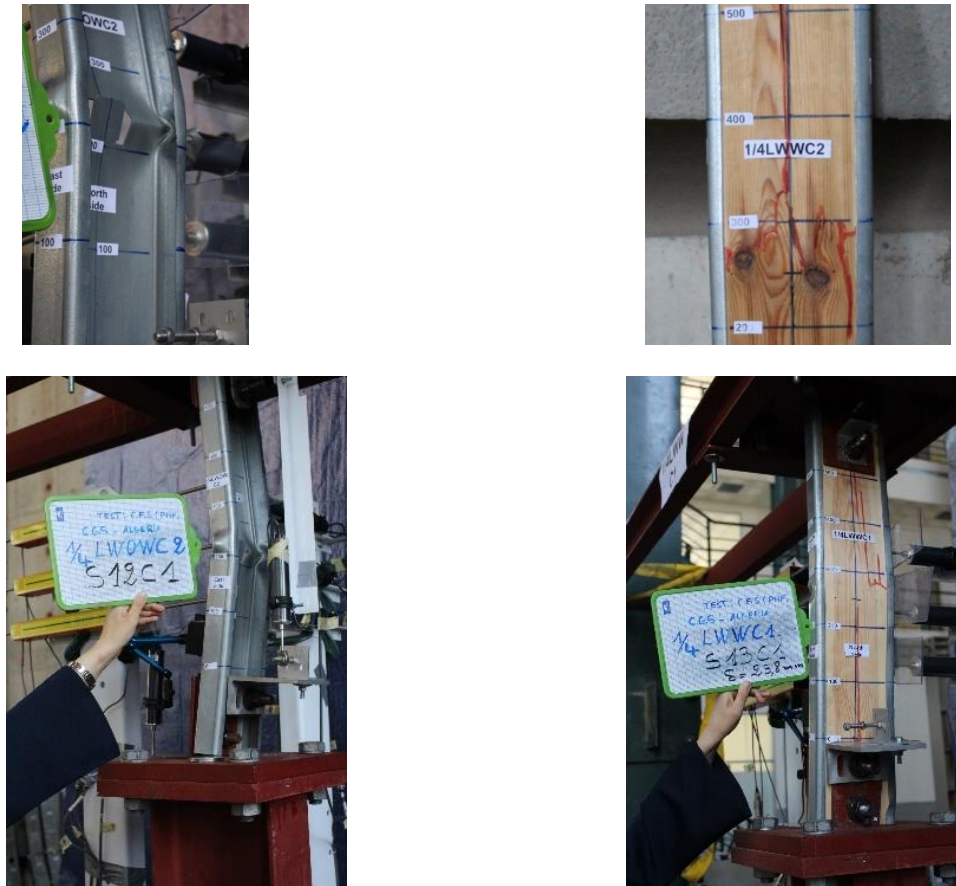
Figure 3.14 : Déformations des spécimens 1/4LWOW et 1/4LWW sous chargement cyclique
