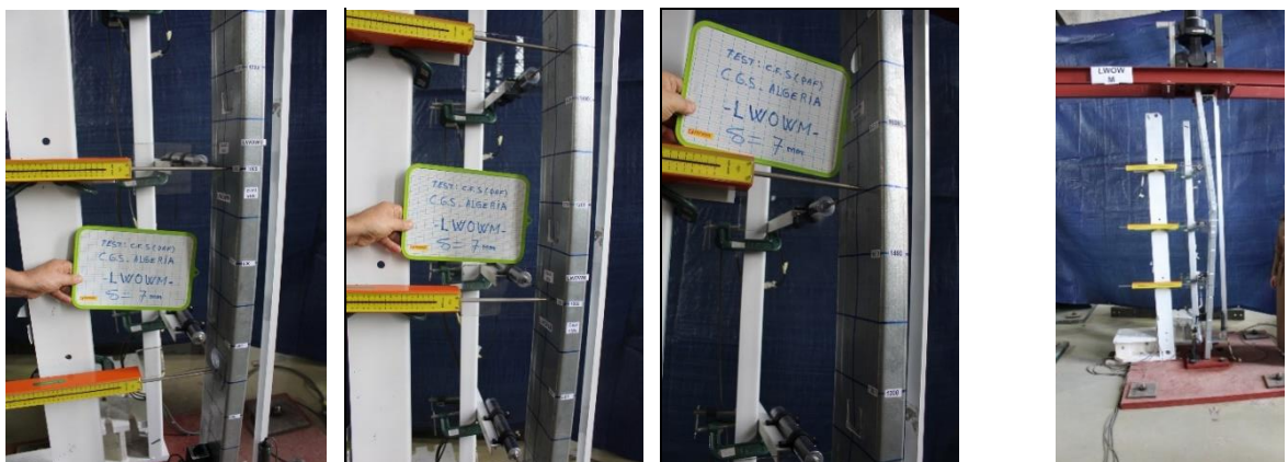
(a) LWOWM- charge de compression maxi (b) LWOWM-Fin de l'essai
