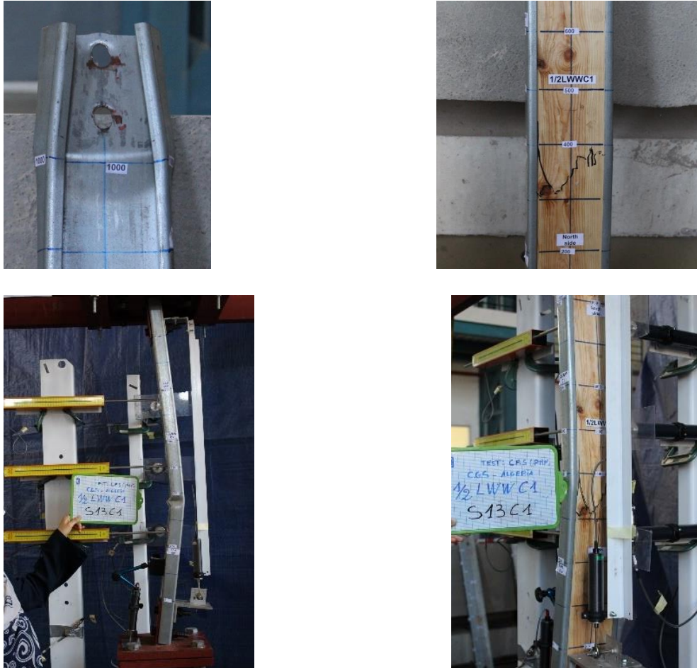
Figure 3.13 : Déformations des spécimens 1/2LWOW et 1/2LWW sous chargement cyclique
