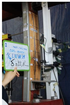
(a) Ecrasement du bois (b) 1/4LWWM-Fin de l'essai Figure 3.10 : Déformée Monotonique - spécimens 1/4LWW
