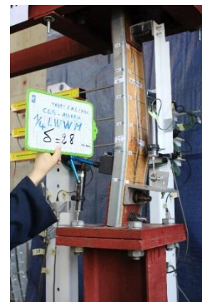
(a) Ecrasement du bois (b) 1/4LWWM-Fin de l'essai Figure 3.10 : Déformée Monotonique - spécimens 1/4LWW
