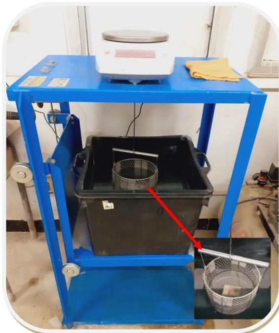
Figure 3. 20 : Balance hydrostatique.
