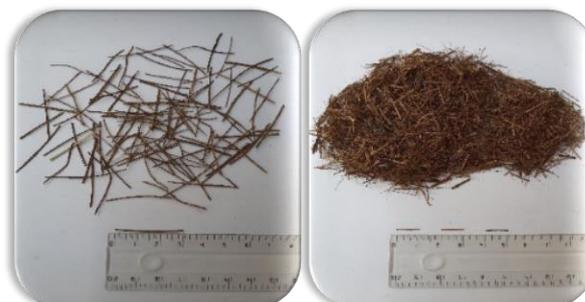
Figure 3. 3: Procédure de préparation des fibres de palmier dattier.
