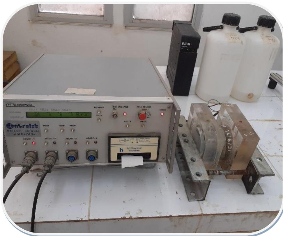
Figure 3. 28 : Appareil de mesure de la perméabilité aux ions chlorés.
