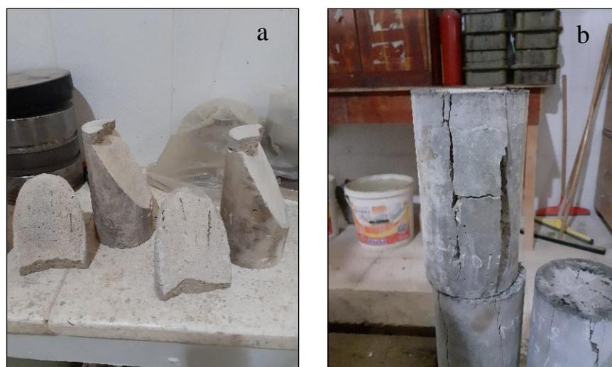
Figure 4. 30: Modes de rupture observés après l'essai de cisaillement oblique.
