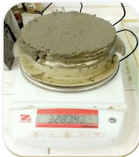
Figure 3. 11 : Mesure des masses volumiques apparentes des mortiers.
