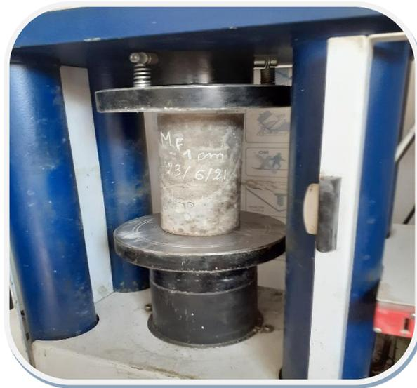
Figure 3. 27 : Essai d'adhérence par cisaillement oblique.
