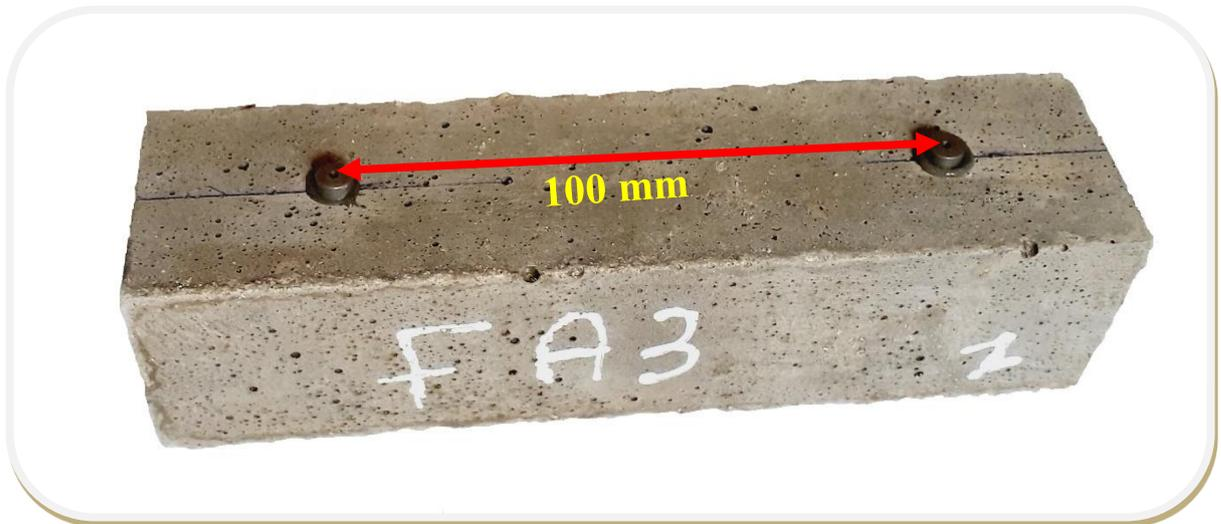
Figure 3. 21: Plots collés sur l'éprouvette.
