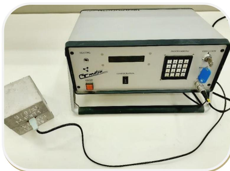
Figure 3. 23 : Essai de la mesure de la conductivité thermique.
