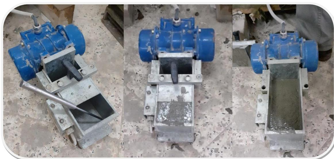
Figure 3. 10 : Ecoulement du mortier avec LCPC.
