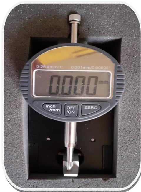
Figure 3. 22 : Comparateur de mesure de déformation (précision  $1\mu$ ).
