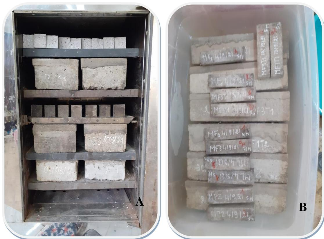
Figure 3. 24 : Essai de séchage- mouillage : A) Séchage et B) Mouillage.
