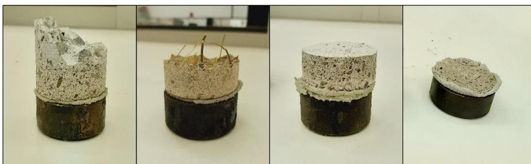
Figure 4. 32: Modes de rupture : (a) dans le substrat, (b) dans le mortier de réparation, (c) à l'interface béton/mortier de réparation, (d) à l'interface époxy/disque.
