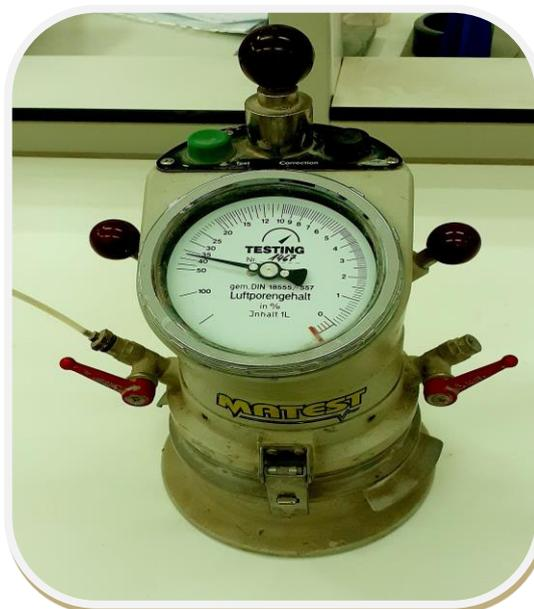
Figure 3. 12 : Mesure de l'air occlus à l'aide d'un aéromètre à mortier.
