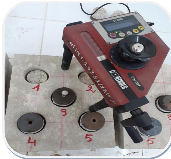
Figure 3. 26 : Appareil d'arrachement utilisé.
