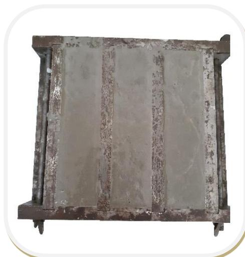
Figure 3. 15 : Moule pour essai sur mortier.
