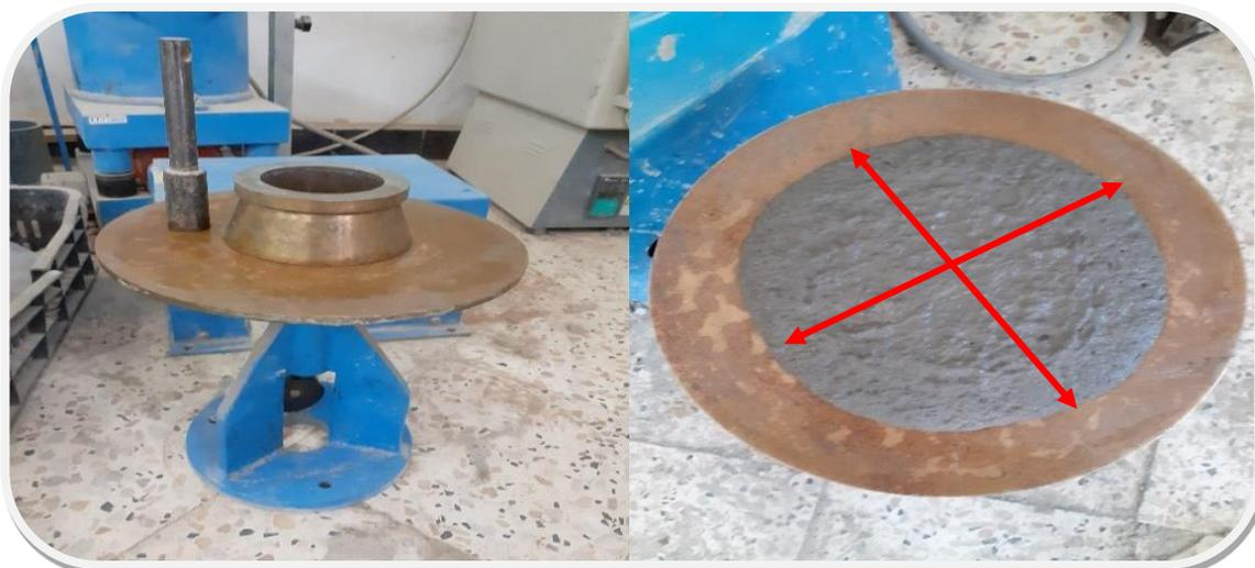
Figure 3. 9 : Etalement de mortier avec la table à secousse.
