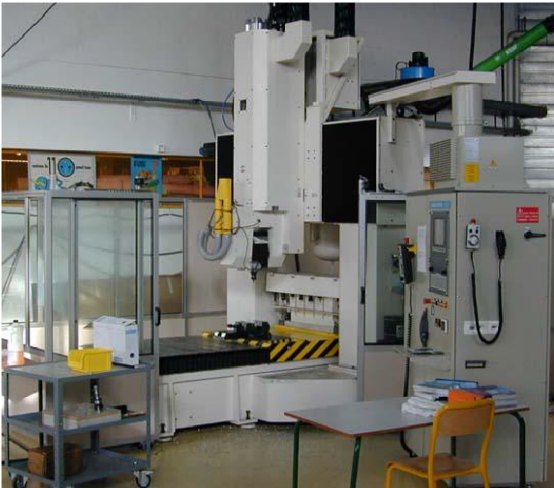
Figure III.8 : Une machine UGV 4 axes dans un environnement scolaire.
