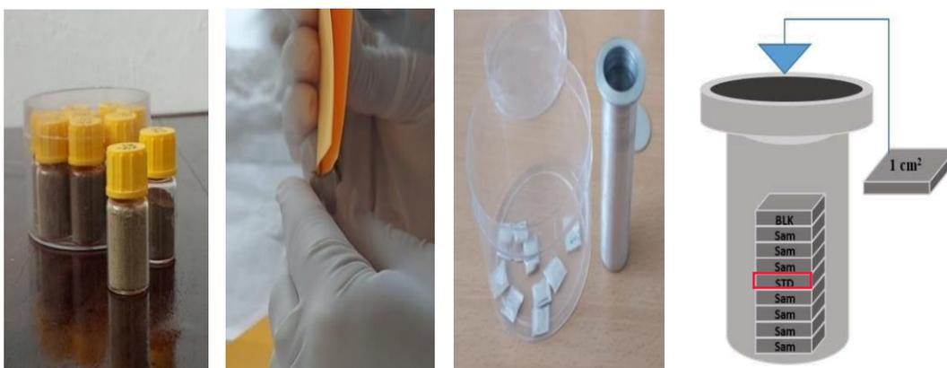
Figure 3. 1: Procédure de préparation de la capsule d'irradiation
