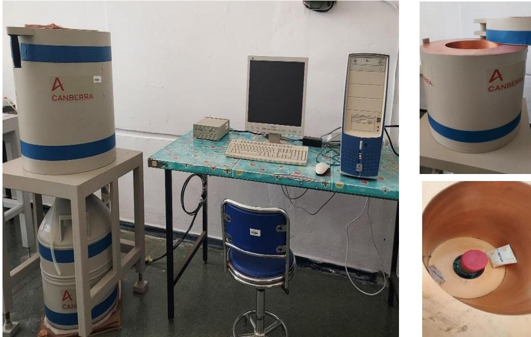
Figure 3. 2: Dispositif expérimental de la technique de spectrométrie gamma
