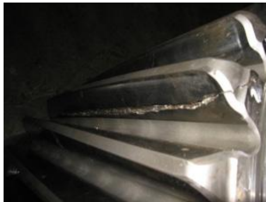
Figure 1.22 Fissuration ou crack d'un engrenage.
