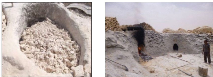
Fig.32. Poudre de gypse et Four à plâtre. Koucha
