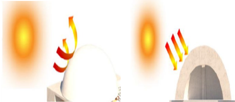
Figure.30 : apports solaires et forme de toiture.
