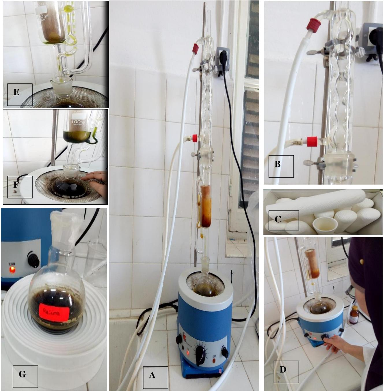
Figure 15. Étapes de la séparation de l'analyte de l'échantillon à l'aide de l'extracteur de Soxhlet. Source personnelle 2023.
