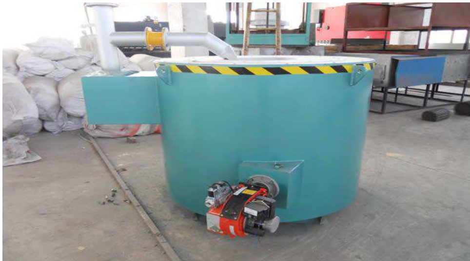
Figure III.1 : un four à gaz de marque CIFE Impianti
