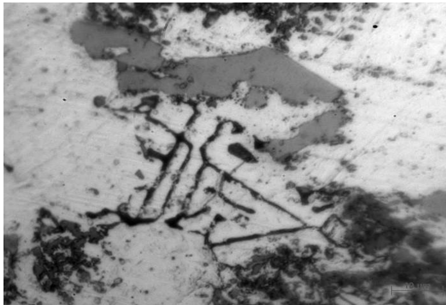
Figure IV.1.4. Microstructure de l'alliage M4 avant traitement thermique
