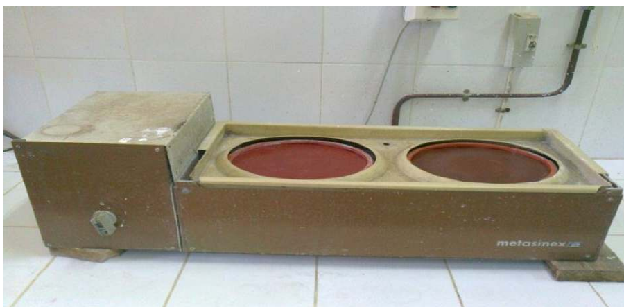
Figure III .12 : Appareil de polissage de finition
