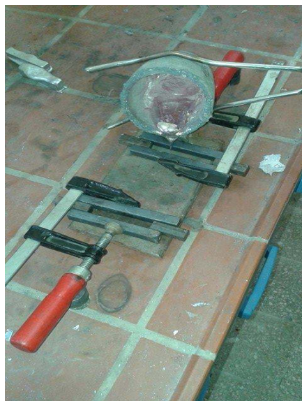
Figure III .4 : creuset en graphite et moule à lingot ouvert en acier
