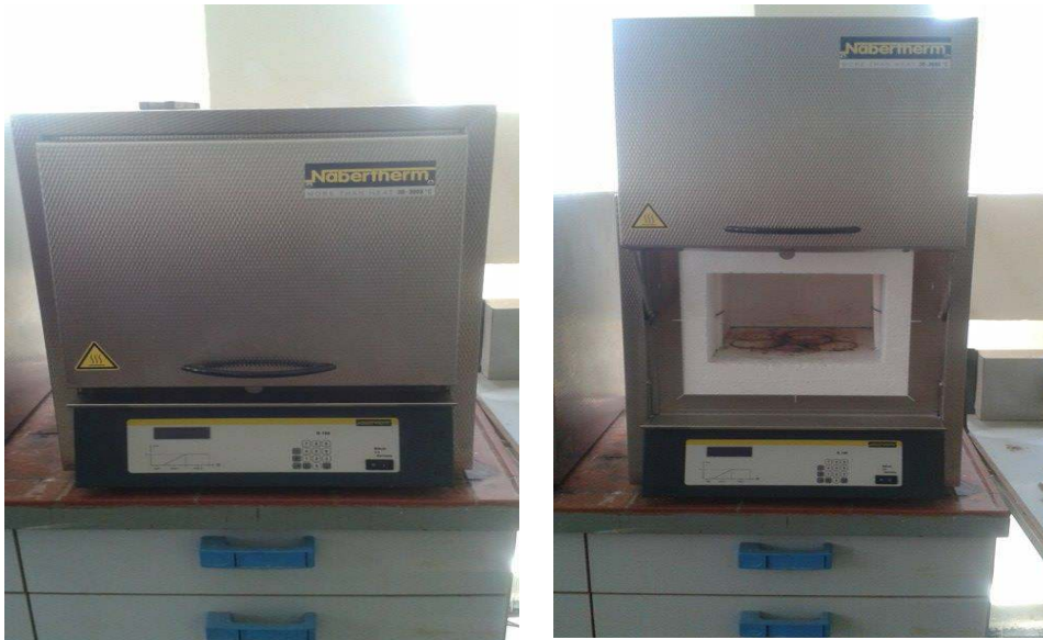
Figure III .3 : Le four utilisé pour le traitement de mise en solution
