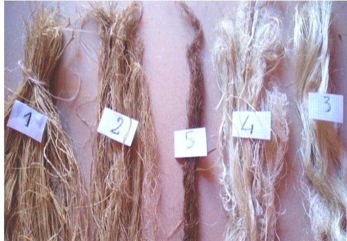
Figure III. 2: Quelques Fibres naturels obtenus par les différents types d'extraction (N°1, 2, 5: fibres Sisal, N°3 et 4: fibres Jonc)
