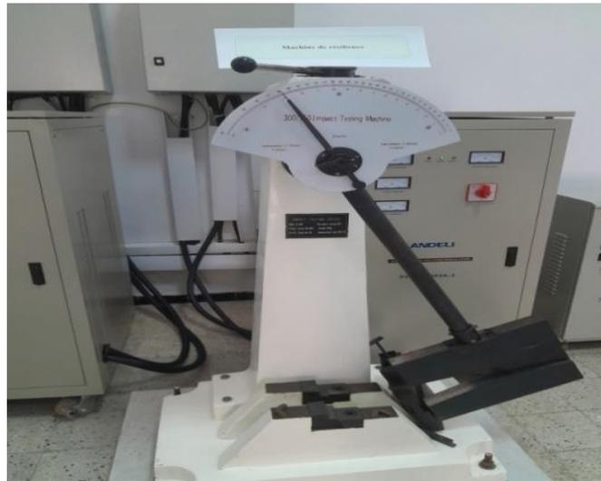
Figure III. 15: Photo d'une machine essais de résilience.
