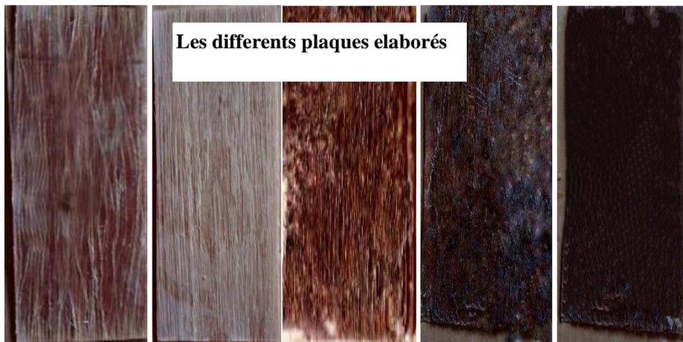
Figure III. 9: a/ Quelques plaques de sisal et jonc élaborées selon le mode d'assemblage.
