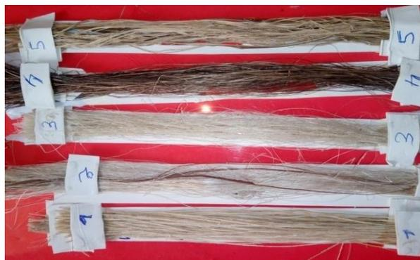
Figure III. 5: Quelques Fibres naturelles obtenus par les différents types d'extraction (N°1, 2, 5: fibres Sisal, N°3 et 4: fibres Jonc)
