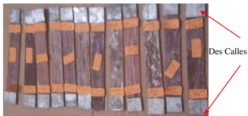
Figure III. 11: Photos des éprouvettes élaborées pour essais de traction avec des calles.
