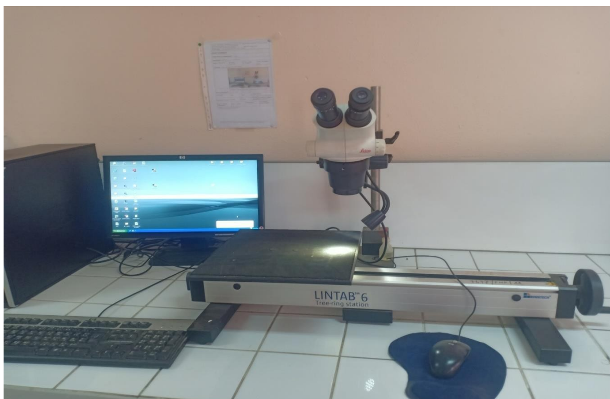
Figure 13: dispositif d'inter-datation et de mesure des épaisseurs des cernes.
