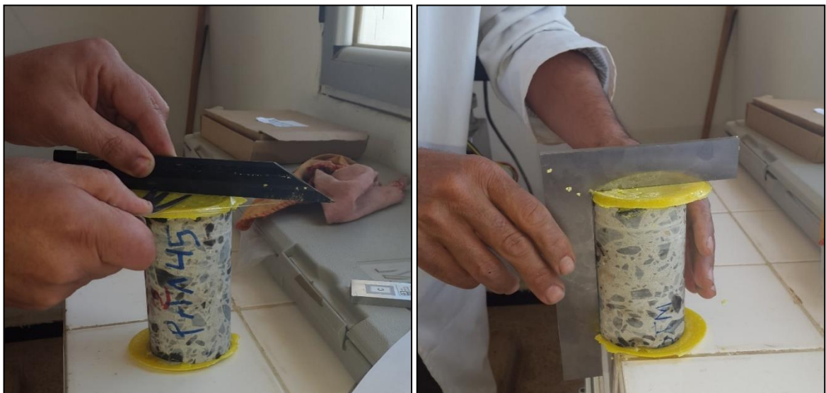
Figure 4. 7 : Vérification de l'alignement et la verticalité.
