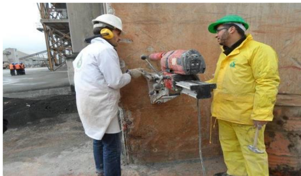
Figure 2. 5 : Prélèvement de carottes (photo SCTE).
