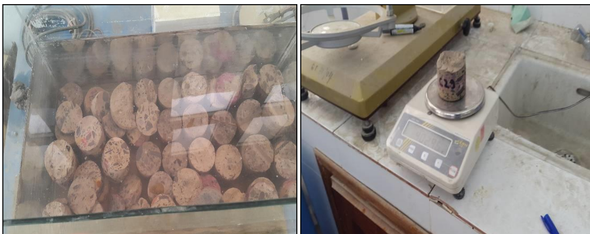
Figure 4. 9 : Mesures de l'absorption d'eau du béton (masse de l'échantillon avant et après immersion dans l'eau).
