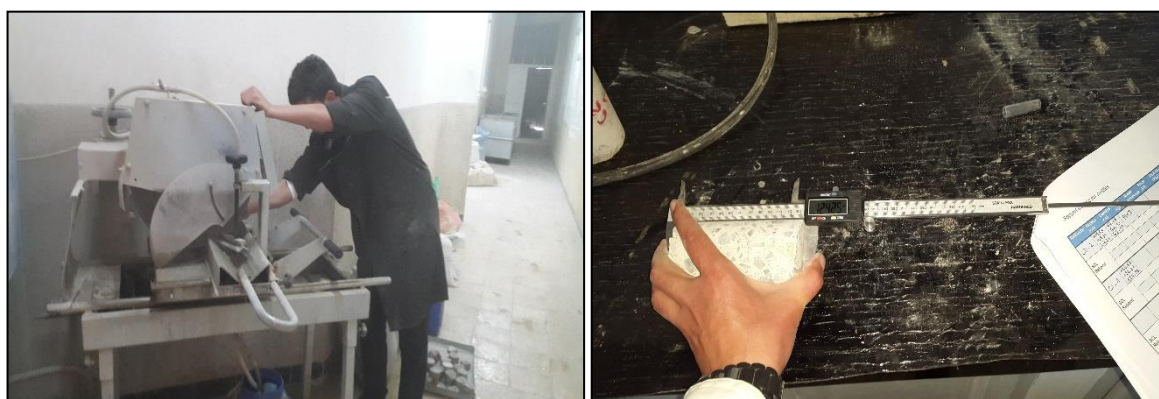
Figure 4. 5 : Découpage et mesure des dimensions des carottes.
