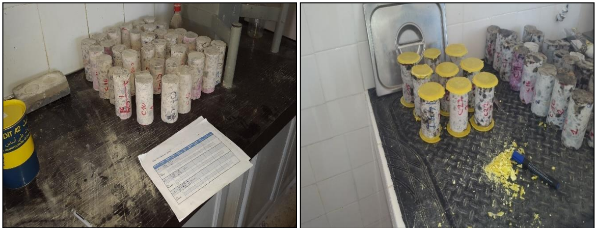
Figure 4. 6 : Surfaçage et préparation des carottes.
