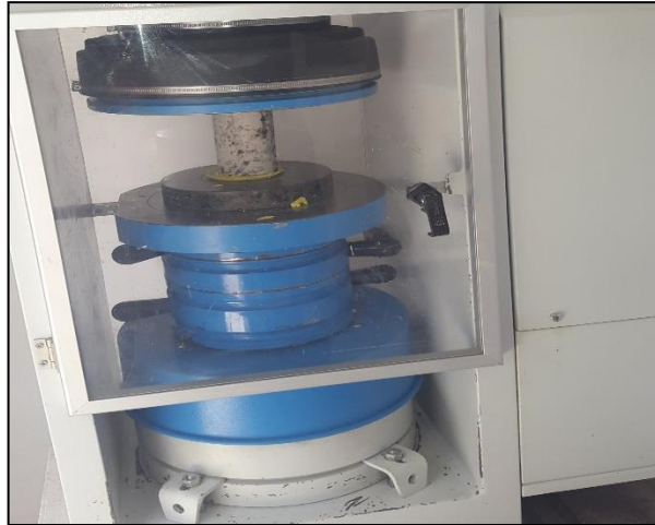
Figure 4. 8 : Essai d'écrasement sur les carottes.
