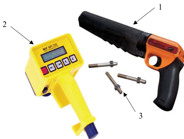
Figure 2. 11: Appareil de résistance à la pénétration (Sonde Windsor) Pistolet (1), démo d'affichage (2), Sondes (3).
