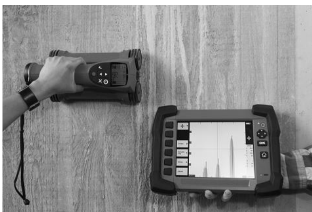
Figure 2.15 : Exemple de localisation des barres d'acier et de mesure d'enrobage par le FerroScan [67].
