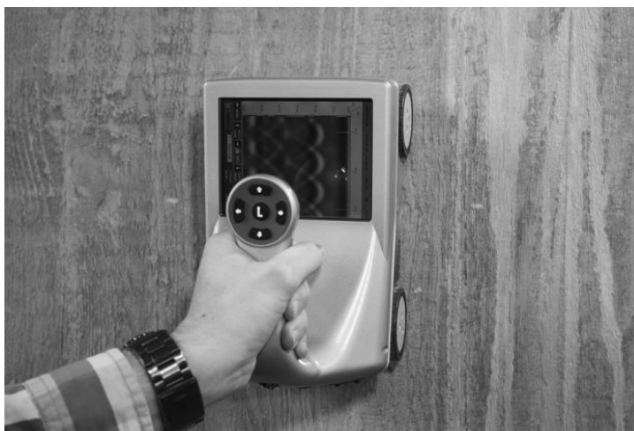
Figure 2.10 : Un géoradar portable durant l'opération [67] .
