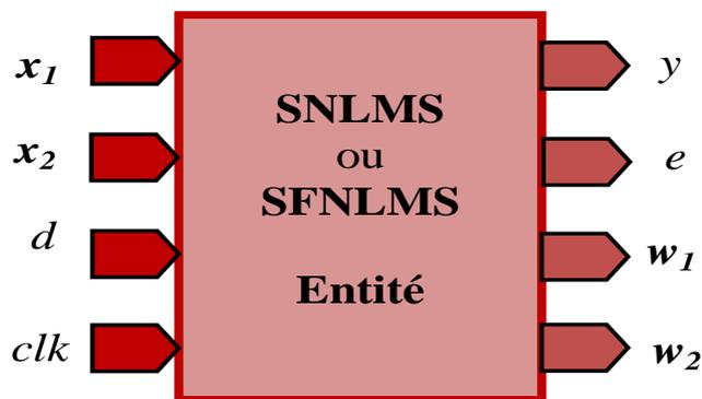
**Figure 6.5.** Interface externe de l'algorithme SNLMS/ SFNLMS en VHDL.
