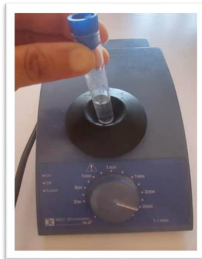
Figure 32 : Homogénéisation automatique de la solution par l'agitateur (Photo originale).
