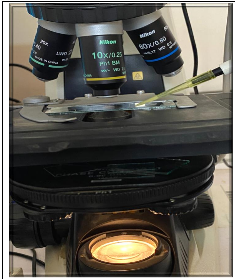
Figure 26 : Observation de la MI par le système CASA ( Photo originale ).
