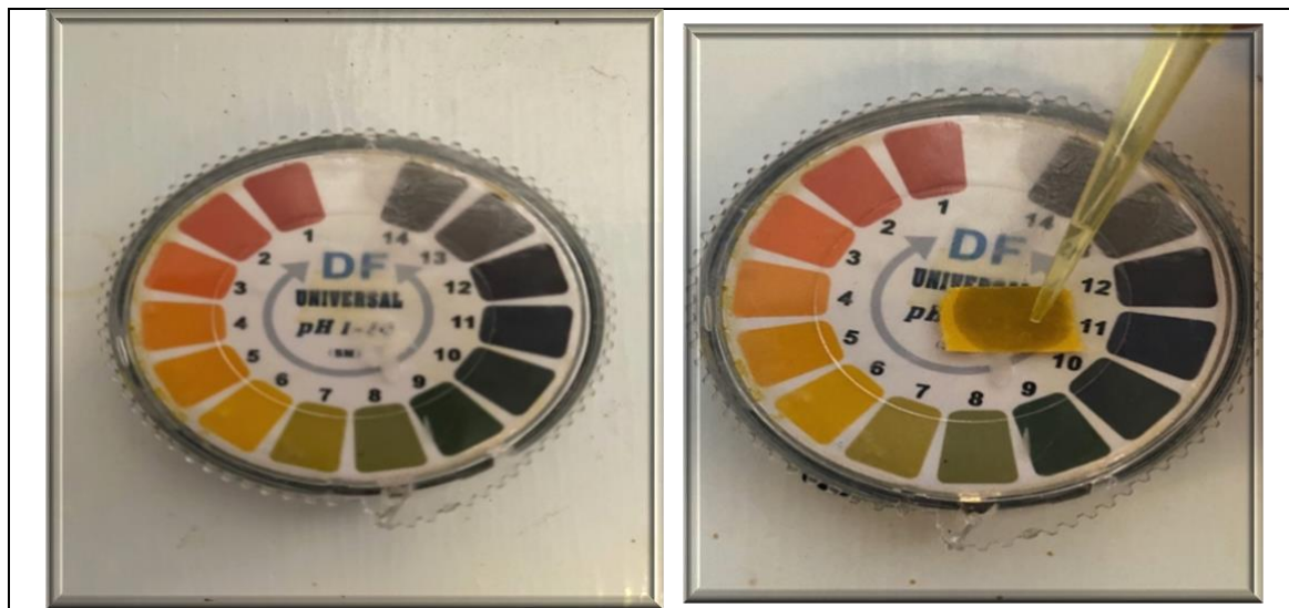
Figure 22 : Mesure du ph (Photo originale).
