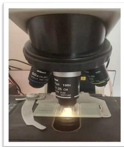
Figure 33 : Observation de la cellule de Thoma sur le microscope (Photo originale).
