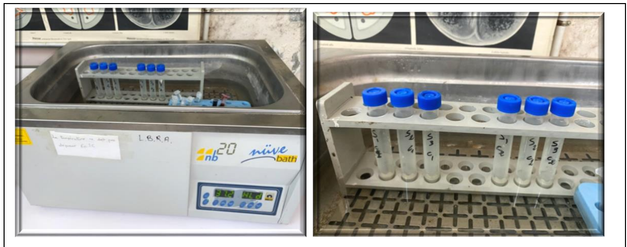
Figure 23 : Conservation des échantillons à 37°C dans un bain-marie (Photo originale).
