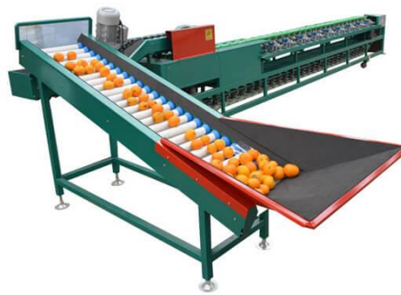
Figure 8 : Système de tri de fruits et légumes
