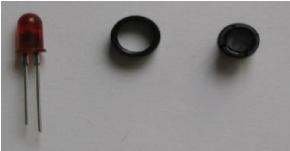
Figure (VI.8) : photo d'une LED rouge avec son support pour châssis
