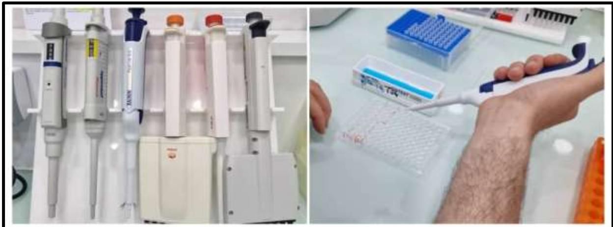
**Figure 12:** Pipettes de précision mono et multicanaux.
