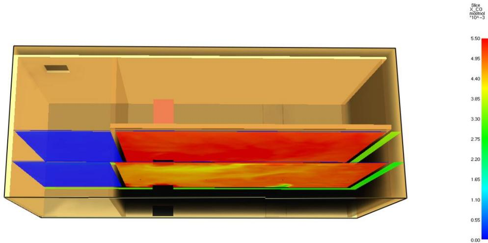
**Figure 3.40** : Contours de monoxyde de carbone après 1200s (cas 2.1 CO Yield=1.6)
