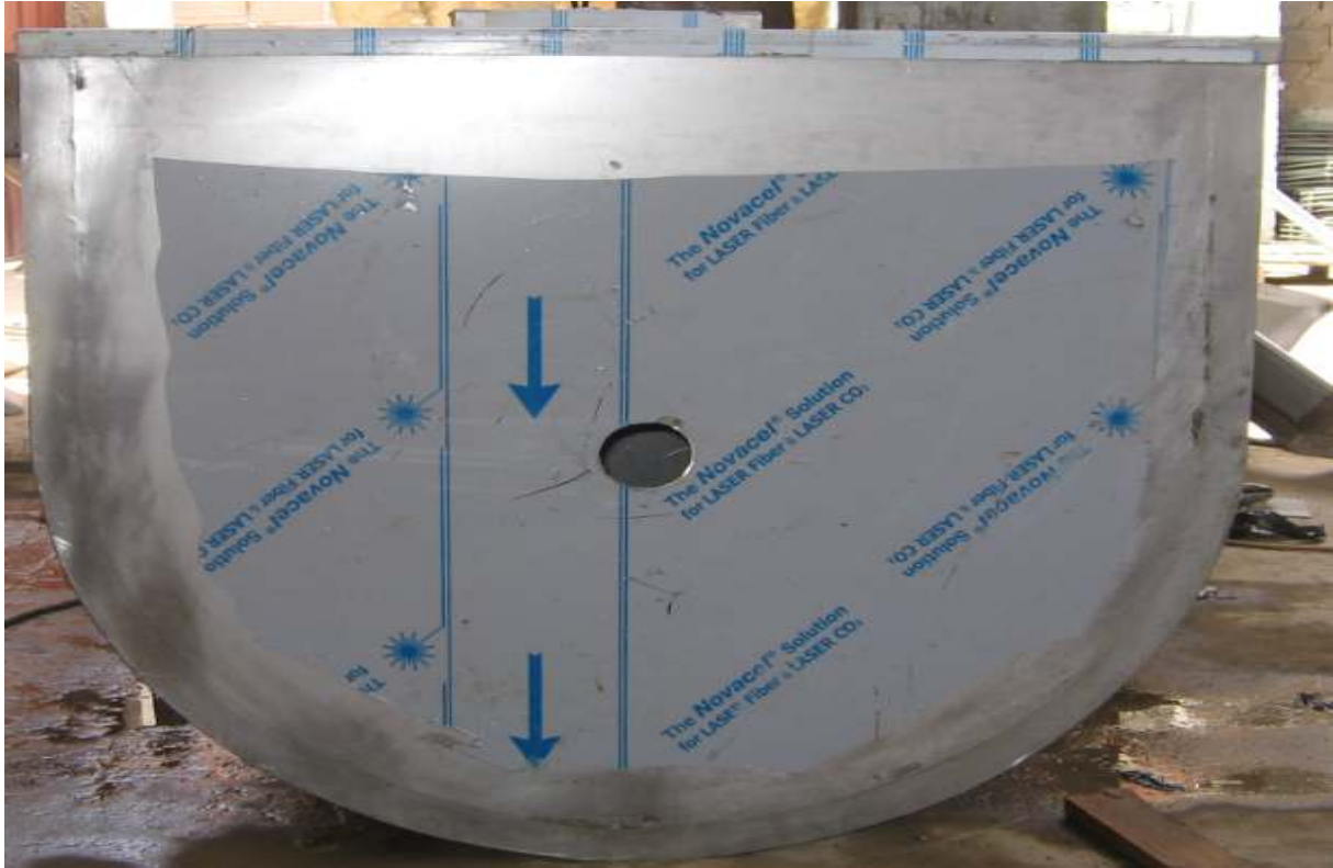
Figure 4.26 : Bridelatérale du mélangeur
