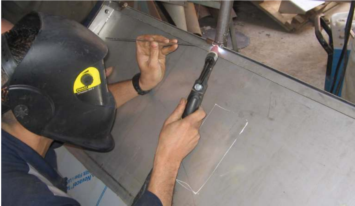
Figure 4.28 : Soudage par TIG
