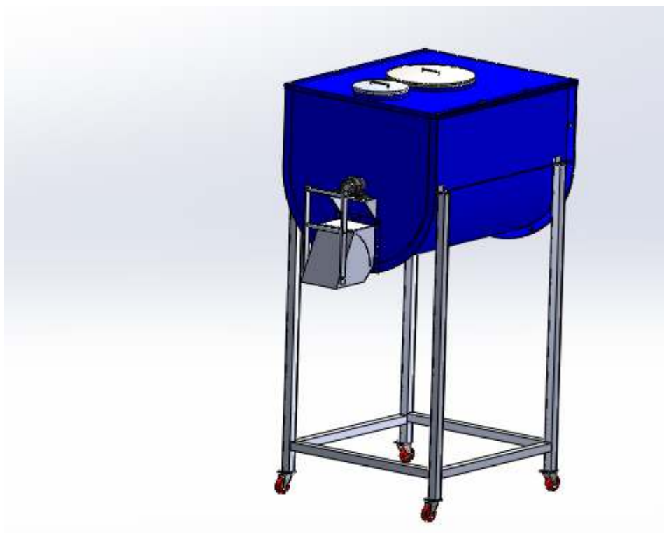
Figure 4.25 : Modélisation du mélangeur
