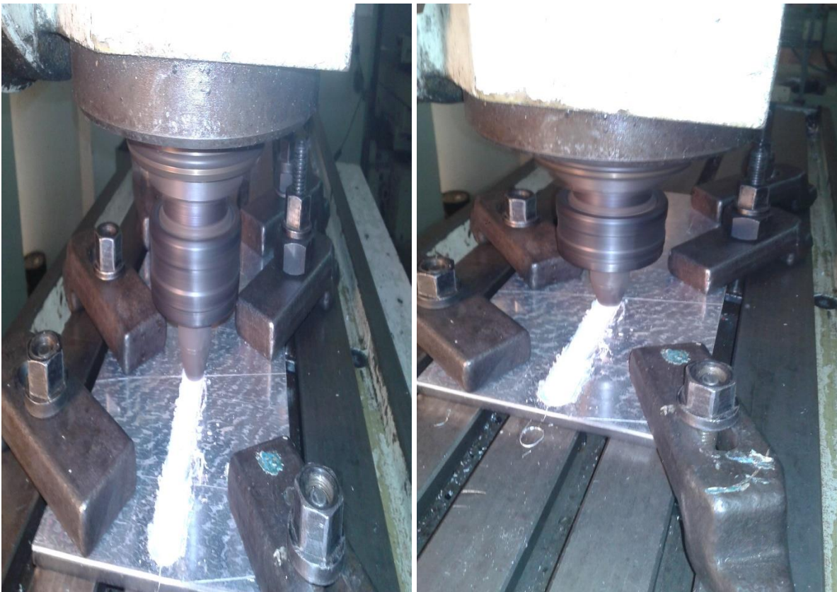
Figure III-5 : Le soudage des tôles
