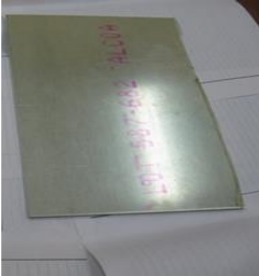
Figure III-1 : Plaque brute d'aluminium 7075 T6 (épaisseur = 3 mm)
