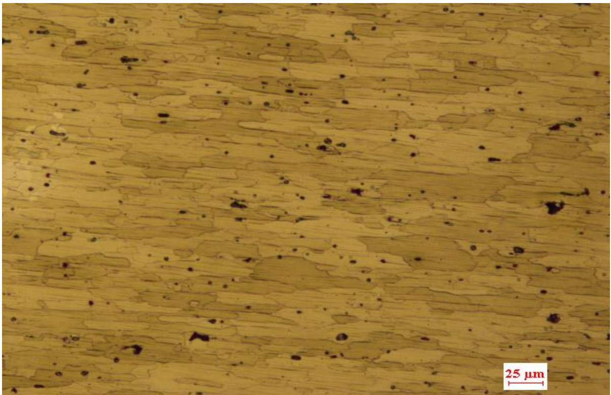
Figure IV-2 : la microstructure du métal de base traité thermiquement.
