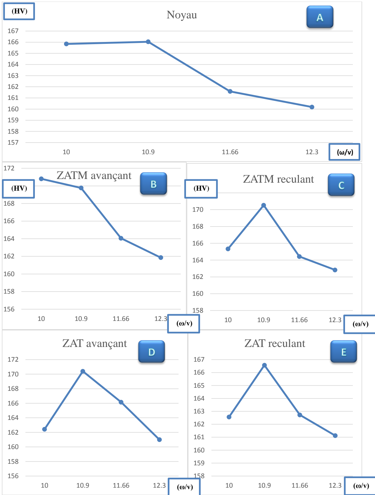
Figure IV-17 : la micro-dureté en fonction du rapport des vitesses dans : (A) Noyau, (B) ZATM avançant, (C) ZATM reculant, (D) ZAT avançant, (E) ZAT reculant.
