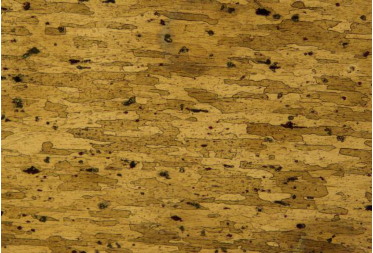
Figure IV-1 : la microstructure du métal de base non traité.
