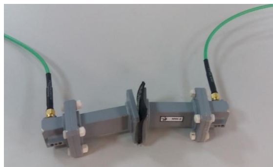
Figure V.5: Disposition de l'échantillon dans le guide rectangulaire
